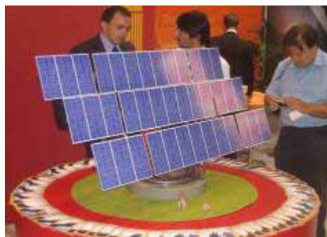
Bild 8. Tvåaxlig solföljning från spanska Soltec Energías Renovables
