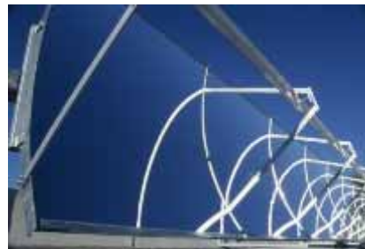
Bild 11. ANU Koncentrerande, vatten- kylda system Chaps
