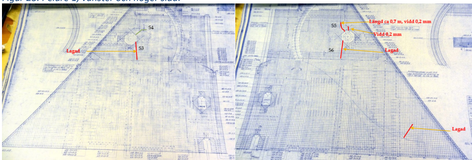
Figur 24. P1v och P1h med observerade sprickor inritade.
