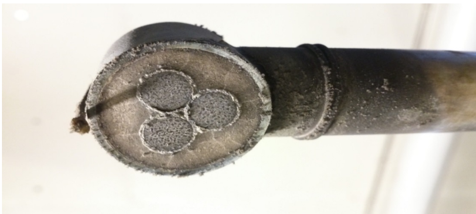
Fotografi taget på korrosionssond efter försök med träflis + 3% svavel. Rökgas temperatur: 250°C.
