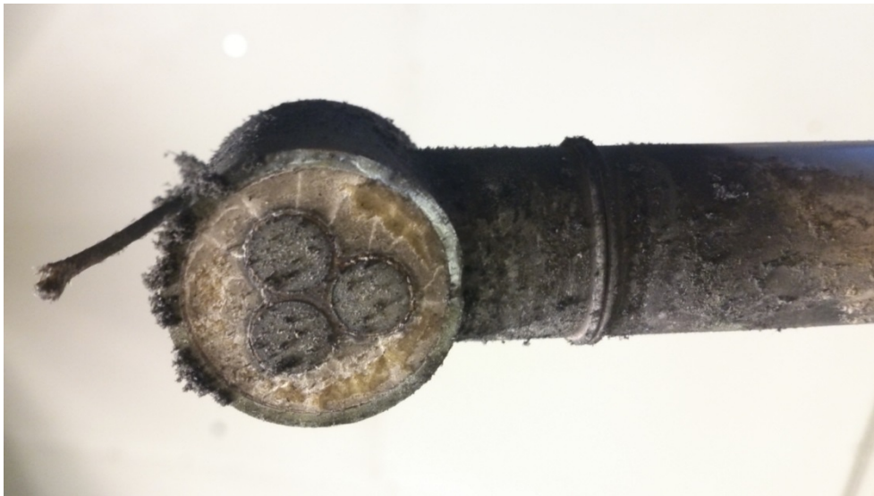
Figur 8. Fotografi taget på korrosionssond efter försök med träflis och 12,4% ammoniumsulfat.
