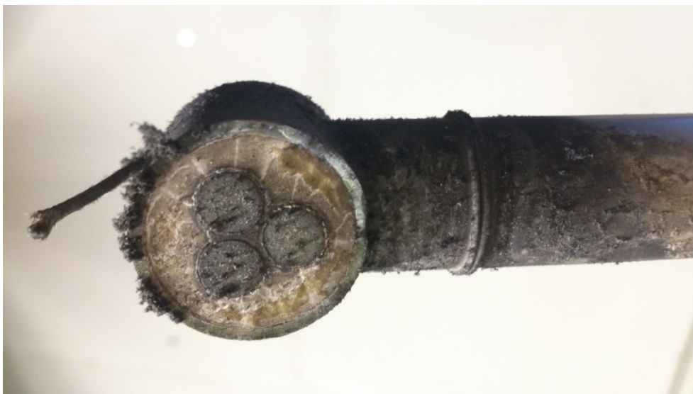
Fotografi taget på korrosionssond efter försök med RT-flis + 12,4% ammoniumsulfat. Rökgastemperatur: 200°C.
