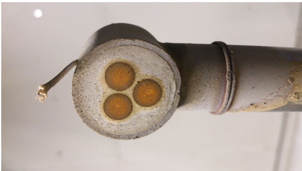
Fotografi taget på korrosionssond efter försök med träflis. Rökgastemperatur: 200°C.
