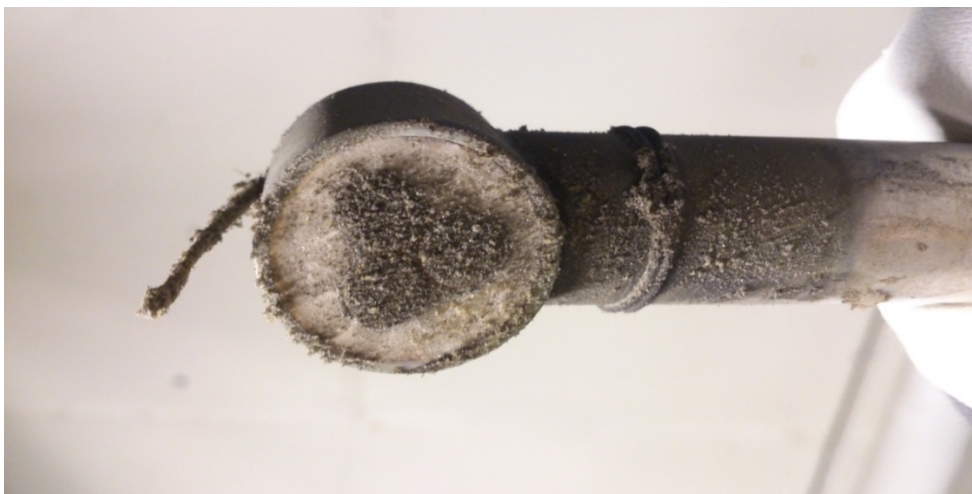
Fotografi taget på korrosionssond efter försök med RT-flis + 12,4% ammoniumsulfat.
