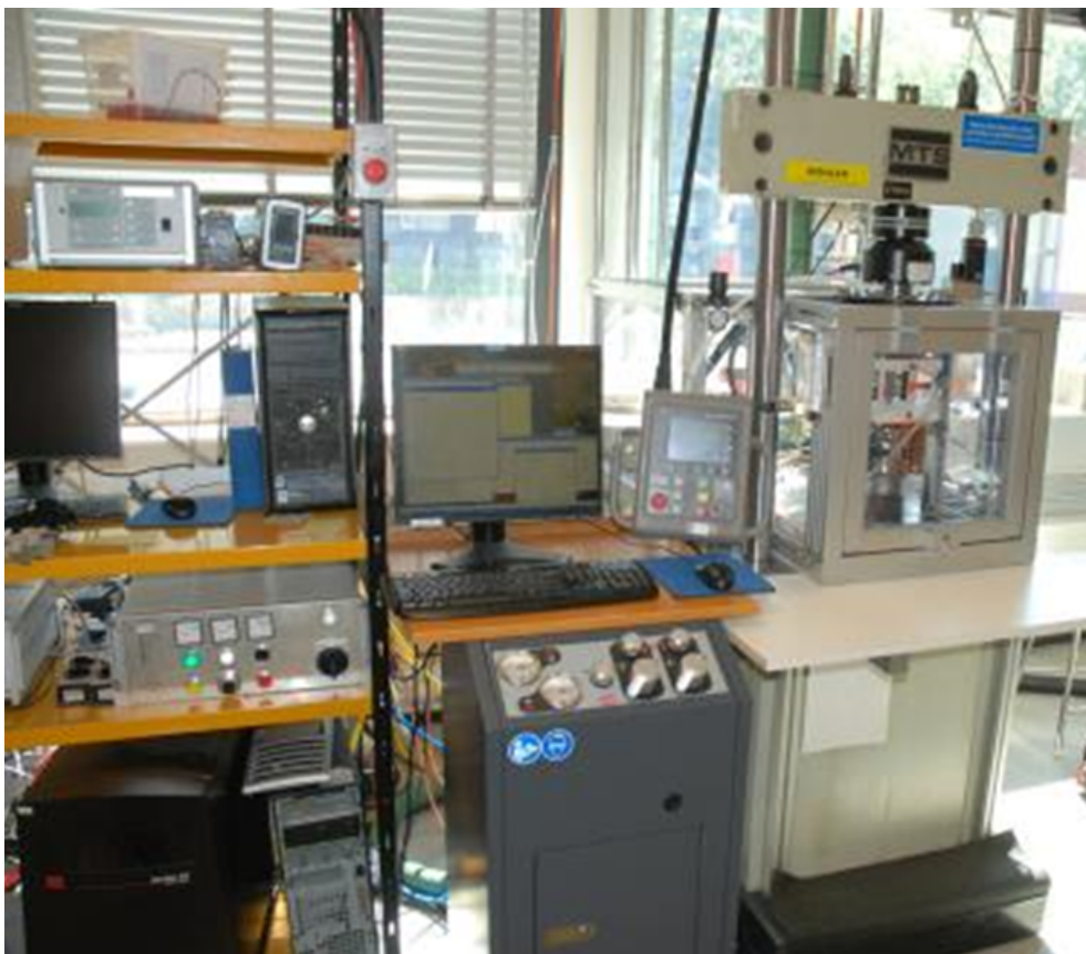
Figur 2. Översiktligt foto av TMF provningsriggen. Utrustning för gastillförsel och –evakuering är utanför bild. Figure 2. Overview of TMF test rig. Equipment for gas supply and evacuation is outside image.
