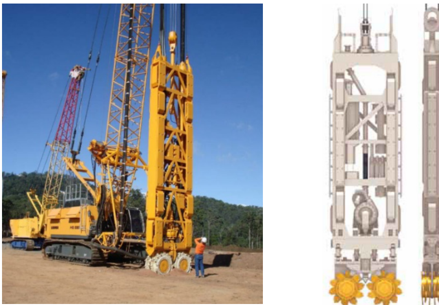
Figur 3.3 – 2 Hydromill lämplig för mycket djupa slitsar, som också kan schaktas in i berget.
