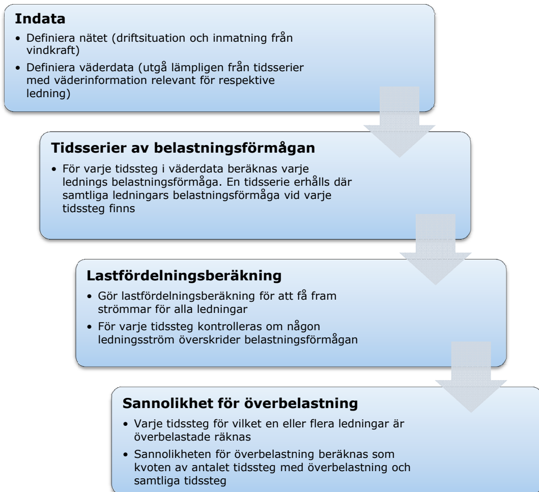
Figur 7.2. Flödesschema som beskriver metod 2 för att ta fram sannolikheten för överbelastning i nätet vid en viss driftsituation.
