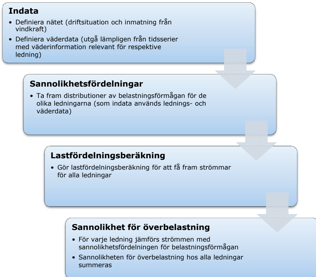
Figur 7.1. Flödesschema som beskriver metod 1 för att ta fram sannolikheten för överbelastning i nätet vid en viss driftsituation.
