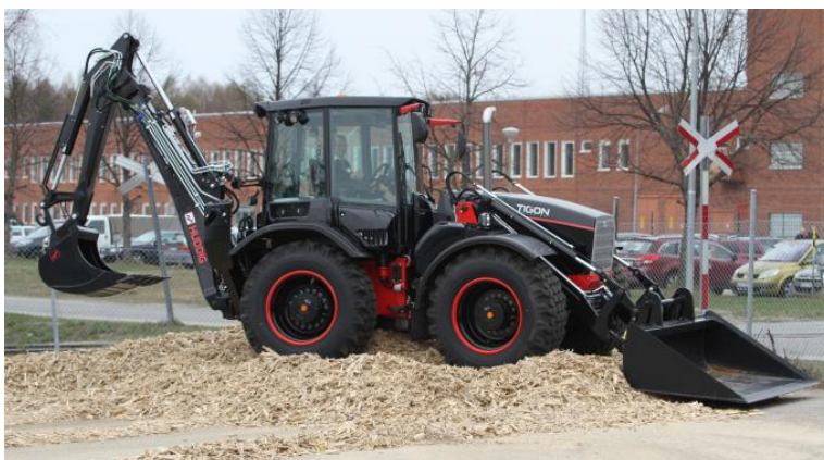
Figur 3 Hybriddriven grävlastare med elhybridkomponenter från Elforest (Elforest, 2016a)
