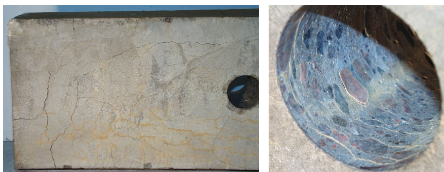
Figur 3-12 Frotskadat oarmerat betongblock, 1×0,4×0,2 m, [MH].
