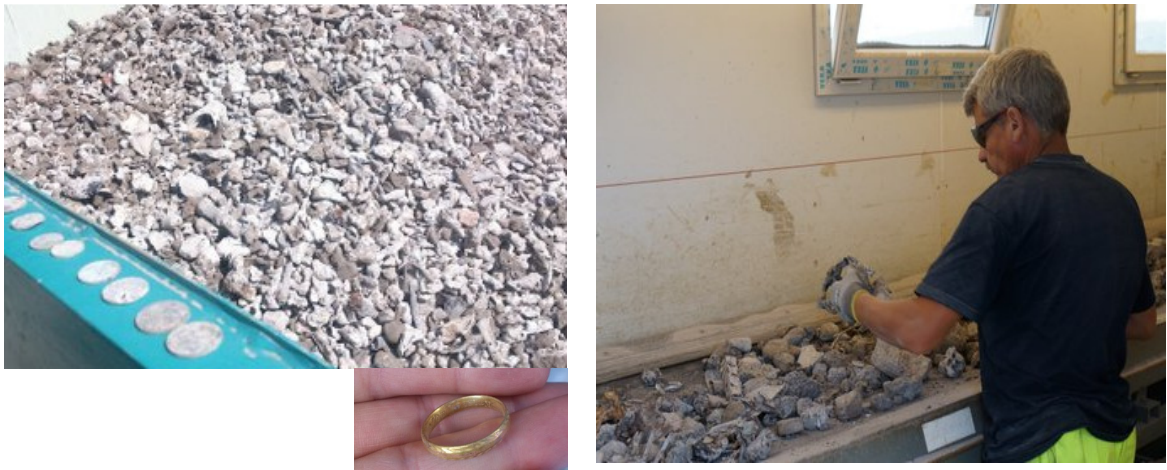
Bild 3. Utsortering av icke magnetiska metaller sker med dels med virvelströms-separator, dels manuellt på plockband. Huvuddelen av det icke magnetiska materialet är aluminium, men även andra metaller förekommer i askan.....
