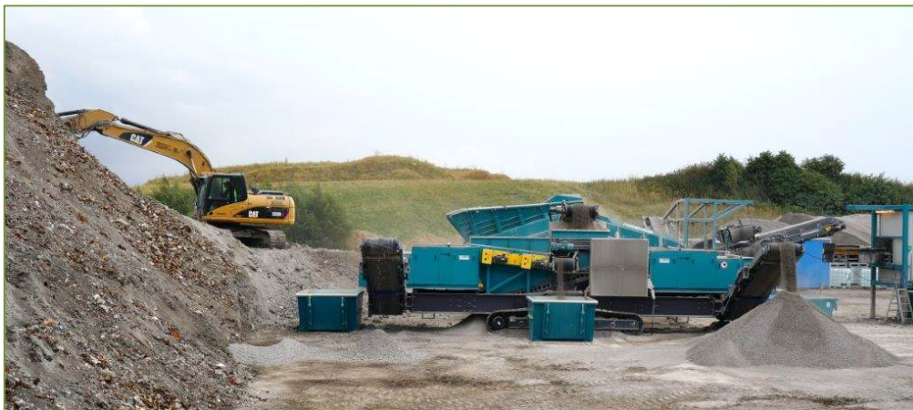
Bild 2. Mobil utrustning för sortering av slagg, Kaabs Nordic/Mobifloat BV
