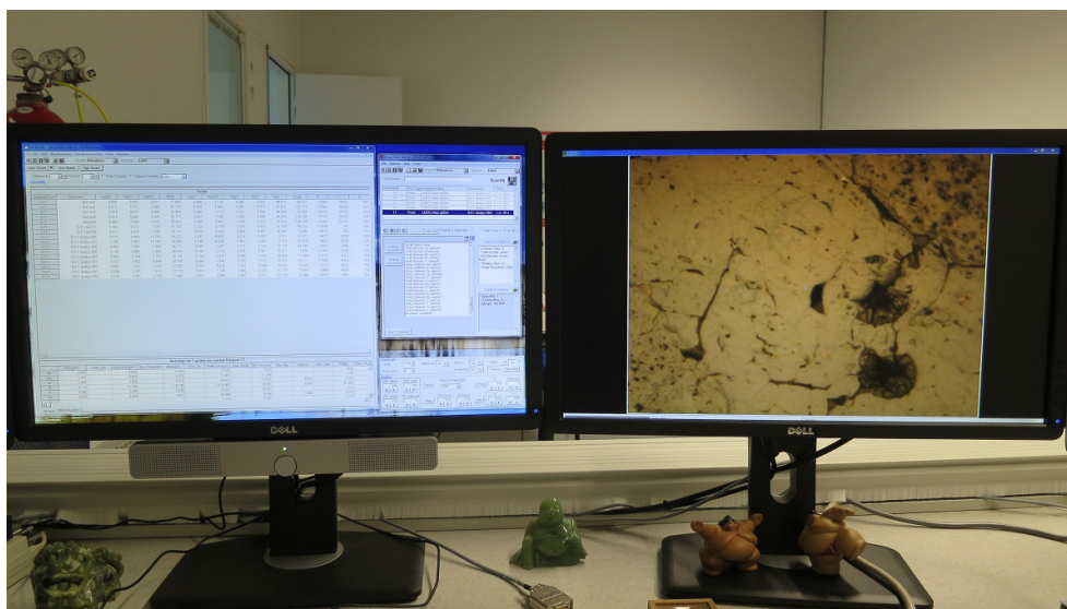
Figur 15. Bildskärmen till höger återger provets yta. Bildens bredd i aktuellt fall motsvarar 500 \mu\text{m} på provet. Bildskärmen till vänster återger i tabellform den kemiska sammansättningen i de punkter som har analyserats.
