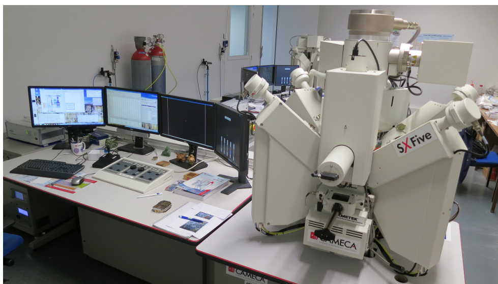
Figur 14. EPMA-instrument av typ Cameca SX Five. Instrumentet omges av fem WDS-spektrometrar, varav fyra är synliga i bilden.
