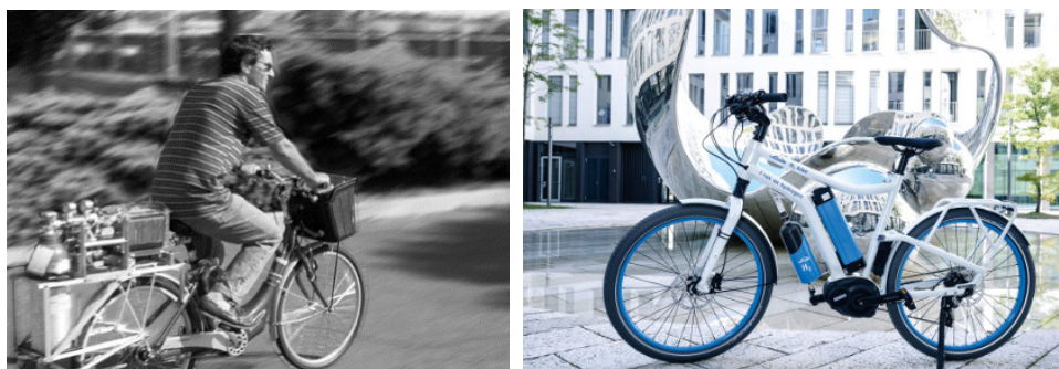
Figur 2. Exempel på tidiga (vänster, ENEA[9]) och mer nutida (höger, Linde[13]) FC-cykeldemonstratorer.
