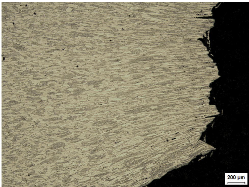
Figur 17 Mikrostrukturen nära brottet i prov 1CrESCW-6, LOM 50x
