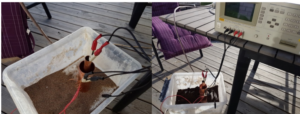
Figur 11 Mätcell inkopplad för mätning av dielektriska egenskaper ( C_p - R_p ) för grus och jord.
