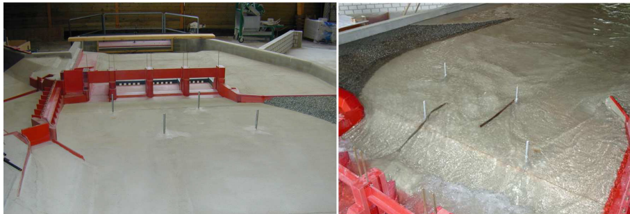
Figur 11 Modellförsök av implementation av deflektorer för Baierbrunn regleringsdamm [14].
