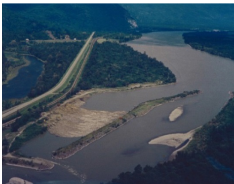
Figur 7 Frazier river drivgodsfälla (tvärström) utnyttjar kurvan åt vänster som för över drivgodset [1].
