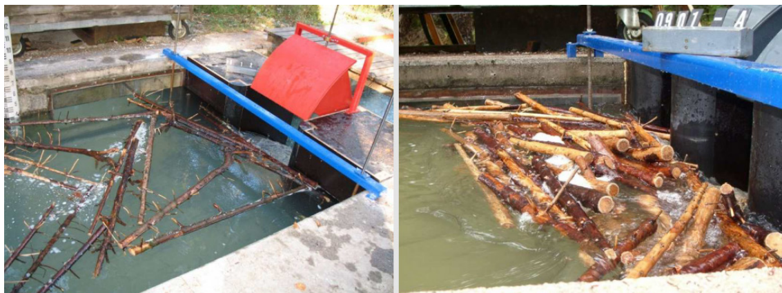
Figur 2 Framtagande av Fr i modellförsök (Till vänster: igensättning ytmatta samt till höger: igensättning dykning)
