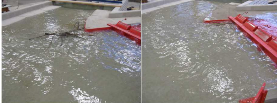
Figur 9 Modellförsök av implementation av kantkonstruktion [14].
