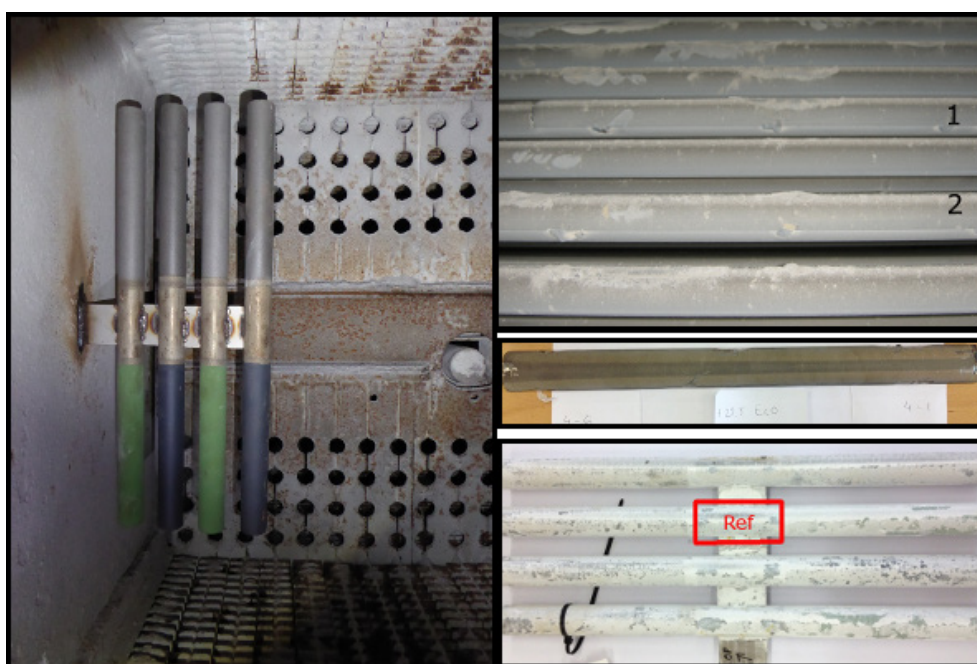
Figur 3. Exempel före och efter exponering i panna. Vänster: Oexponerade prover, Avedöreverket. Höger, överst: Exponerade prover, Västhamnsverket (siffrorna 1 och 2). Höger, mitt: Prov från Västhamnsverket efter exponering. Höger, nederst: Prov från Avedöreverket. Referensdel markerad.
