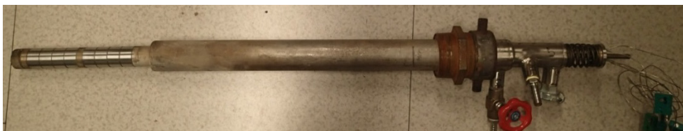
Figur 1. Luftkyld sond som användes under fältförsök i Jordbro.
