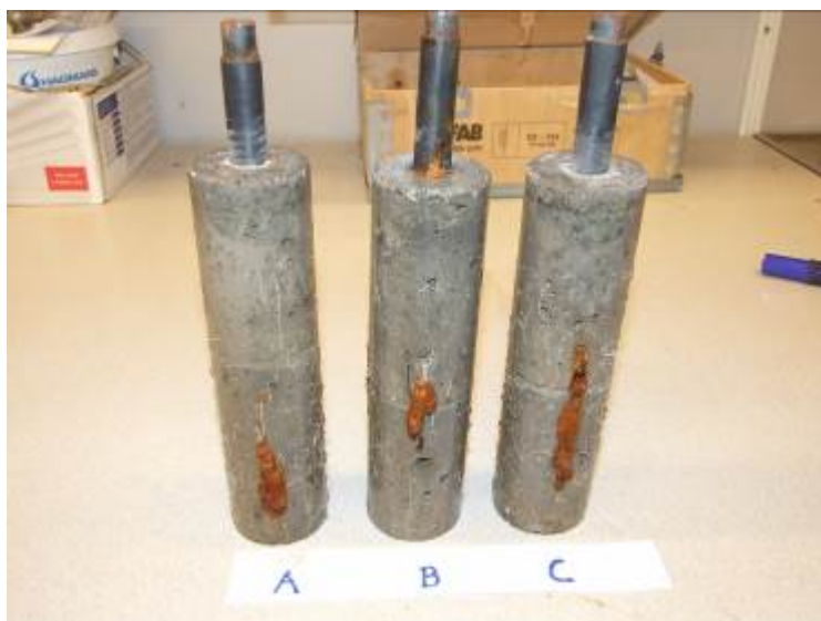
Figur 23. Provtägar i betongcylindrar A, B och C har varit i hopkopplade med rostfria cylindrar i ca 10 veckor i ett vattenbad av 3 % NaCl.
