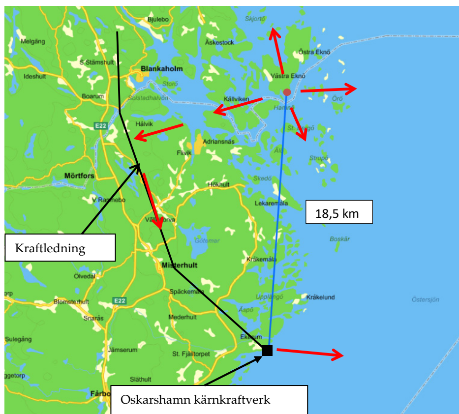
Figur 3. Anger elektrodens placering vid fastlandet (rödmarkerad cirkel) för Gotlandsledningen. Röda pilar anger möjlig strömväg från HVDC-ledningens jordtag in till Oskarshamn kärnkraftverk.
