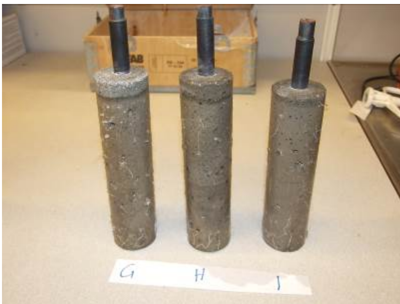
Figur 22. Ej i hopkopplade provstänger av kolstål ingjutna i betongcylindrar G, H och I exponerade i ca 10 veckor i ett vattenbad med 3 % NaCl.
