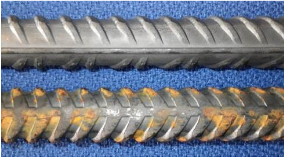
Figur 4. Två kamstål med defekter, där det övre kamstålet har exponerats inomhus i rumstemperatur medan det nedre kamstålet har exponerats en kort tid utomhus, vilket gett lokala korrosionsangrepp i defekter i glödskalet (9)
