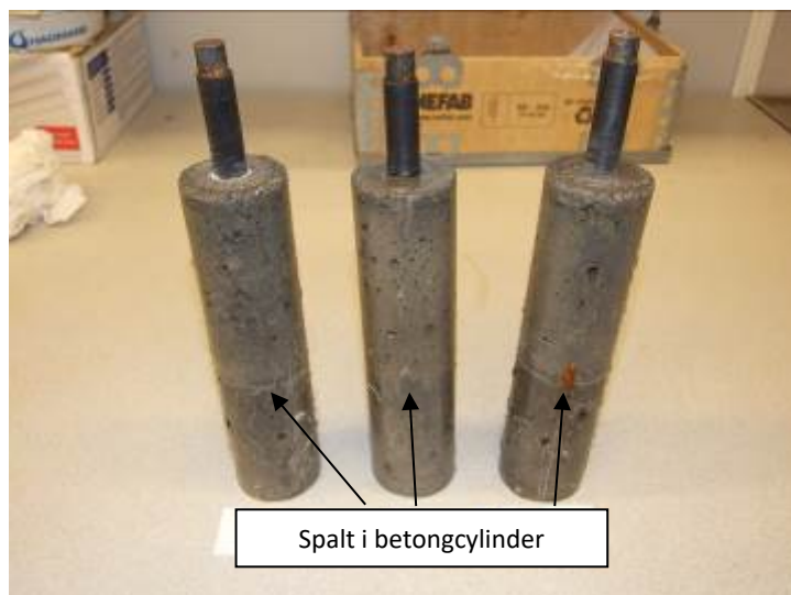
Figur 9. Betongcylindrar med en kontrollerad spalt i betongen
