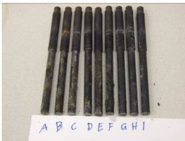
Figur 25. Korrosionsutseendet hos provstänger efter ca 10 veckors exponering i ett vattenbad av 3 % NaCl. Svarta korrosionsprodukter har bildats på stålytan
