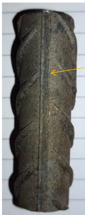
Figur 15: Armeringsyta med endast mindre områden med glödskalet.
