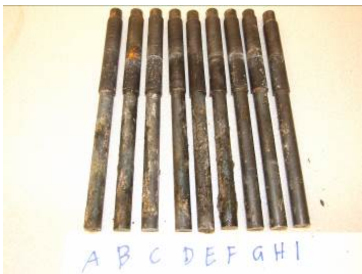
Figur 26. Korrosionsutseendet hos provstänger efter ca 10 veckors exponering i ett vattenbad av 3 % NaCl. Provstängerna har luft exponeras i några timmar på laboratoriet och de svarta korrosionsprodukterna har omvandlats till rödrost
