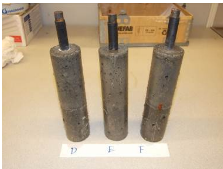
Figur 24. Provtägar i betongcylindrar D, E och F har varit i hopkopplade med cylindrar av titan i ca 10 veckor i ett vattenbad av 3 % NaCl
