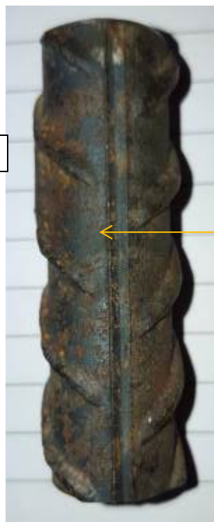
Figur 16: Andra sidan av armeringsytan där större områden av glödskalet är synliga.
