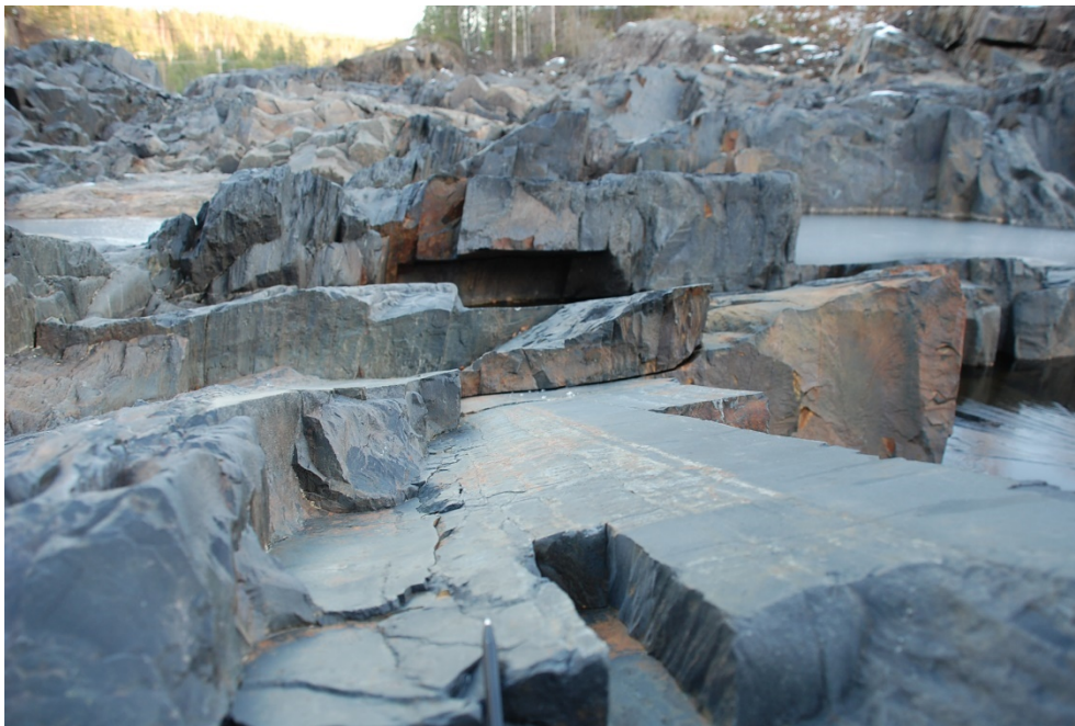
Figur 62 Finnfors. Detalj av flacka bankningsplan. Notera spricköppningen som finns ojämnt fördelad över bergytan.
