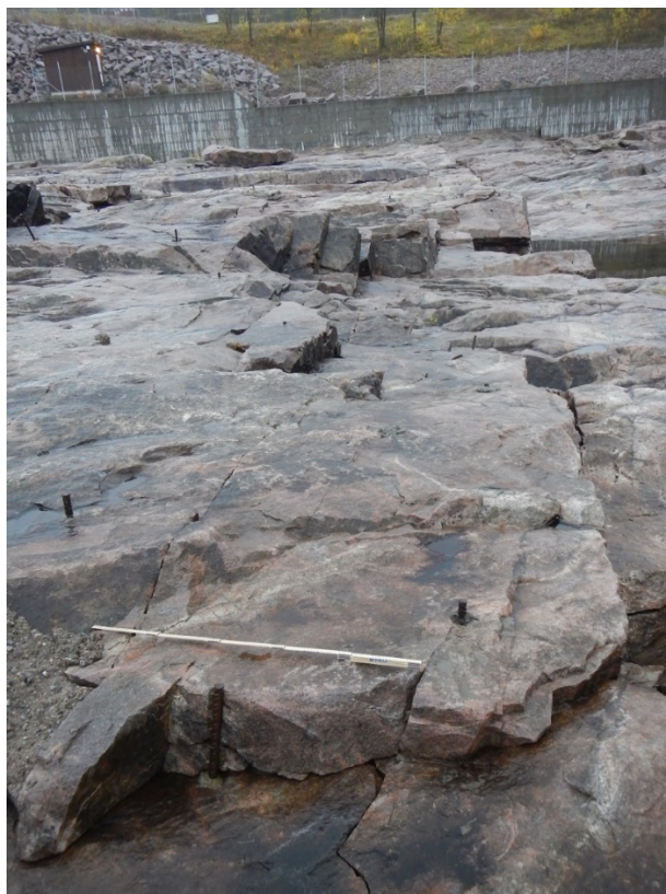
Figur 29 Porjus. Detalj över berggrunden. Notera de flacka bankningsplanen som avskärs av den sprickgrupp som skär flödesriktningen vinkelrätt (från vänster i bild). Notera lösgjorda block och bergförstärkningen.
