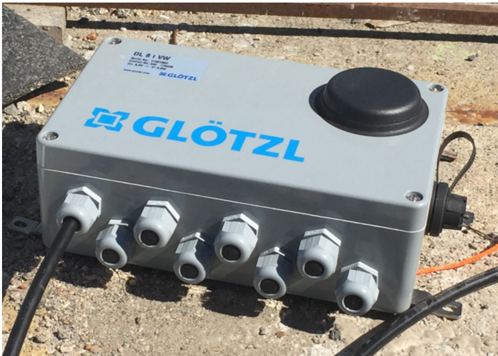
Figur 4.5. Logger med åtta kanaler för lokal lagring av mätdata från lastceller.
