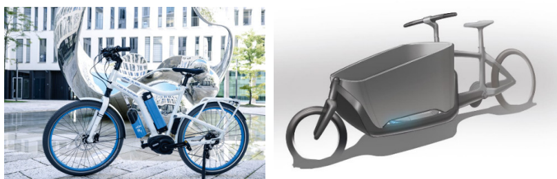
Figur 2. Exempel på nutida FC-cykeldemonstratorer, från a) vänster, Linde[3] och b) höger, pågående utvecklingsprojekt på DLR[4].
