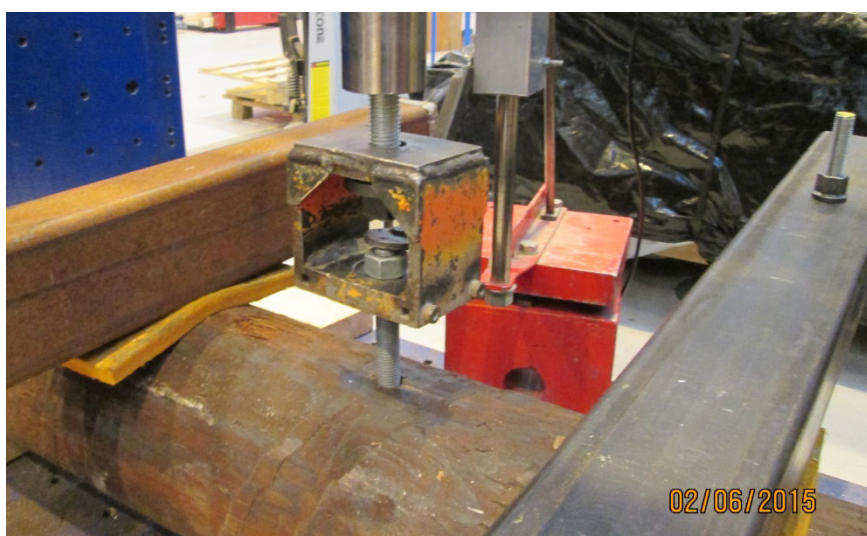
Figur 5: Provuppställning som användes för det horisontella lastfallet vid provning av pinnbult.
