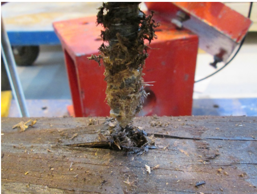
Figur 15: Utfall av provning - utdragning av skruv med förhållandevis lokal skada som följd.
