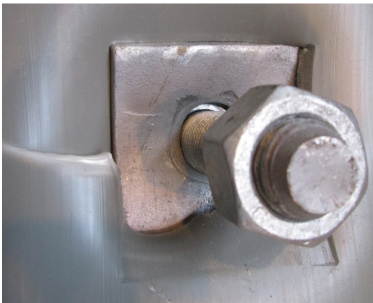
Figur 9: Stansning av bricka till följd av horisontallast.
