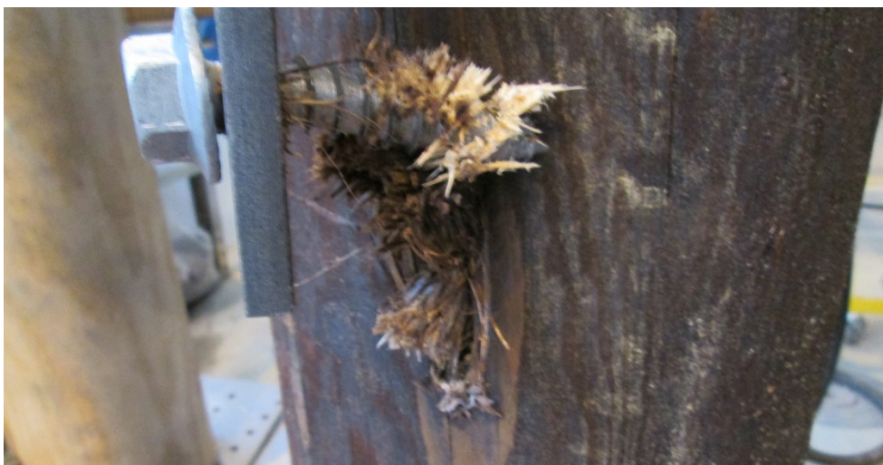
Figur 31: Utfall av provning - utdragen skruv med förhållandevis lokal skada till följd.
