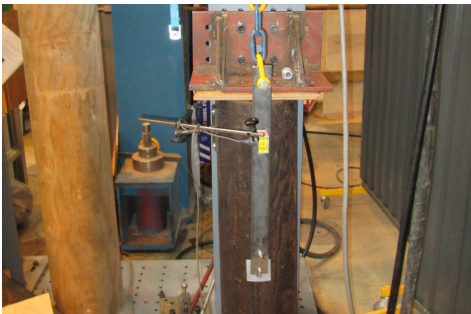
Figur 37: Provuppställning som användes för det vertikala lastfallet vid provning av stagsmärla.
