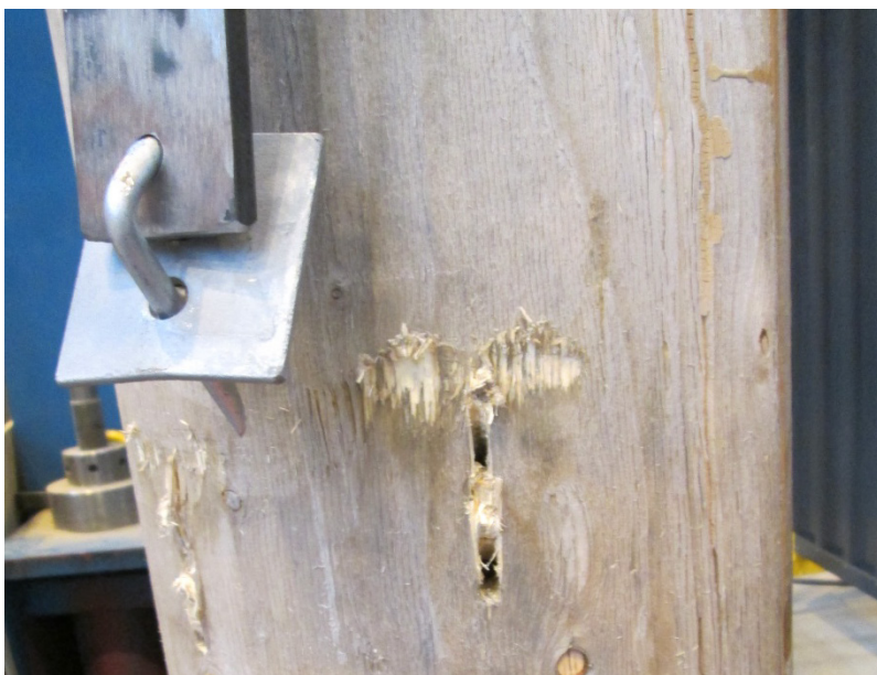
Figur 43: Utfall av provning - utdragen märla med tillhörande lokal skada på stolpen.
