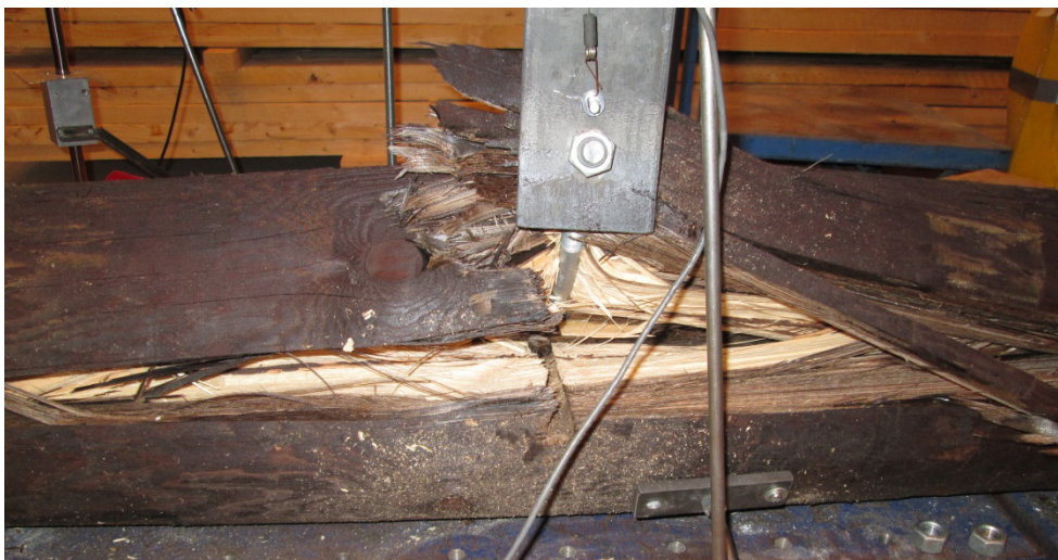
Figur 47: Utfall av provning - pinnbulten skär inledningsvis genom stolpen för att slutligen spräcka upp stolpen.
