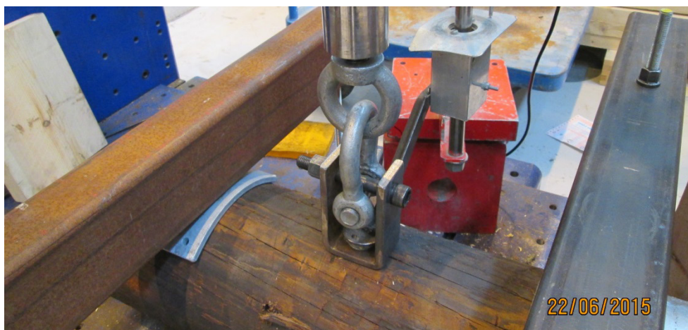
Figur 13: Provuppställning som användes för det horisontella lastfallet vid provning av fransk skruv.
