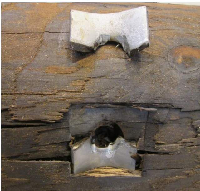
Figur 7: Spräckt bricka till följd av horisontallast.
