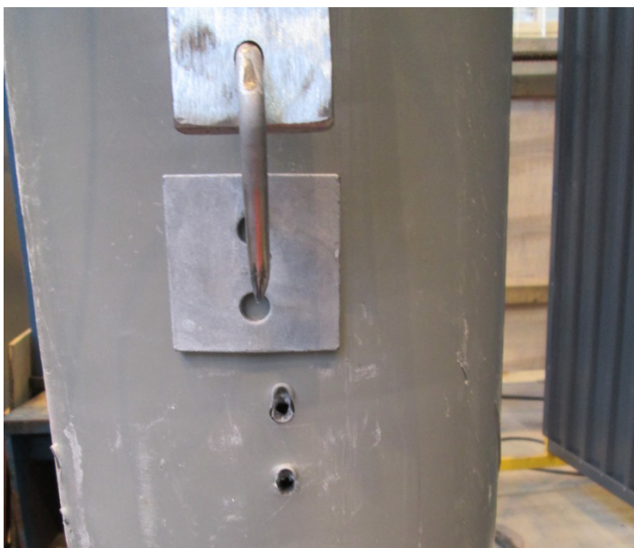
Figur 41: Utfall av provning - utdragen märla med lokal stolpskada.
