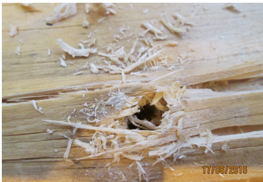
Figur 19: Utfall av provning - utdragning av skruv med lokal skada på stolpen som följd.
