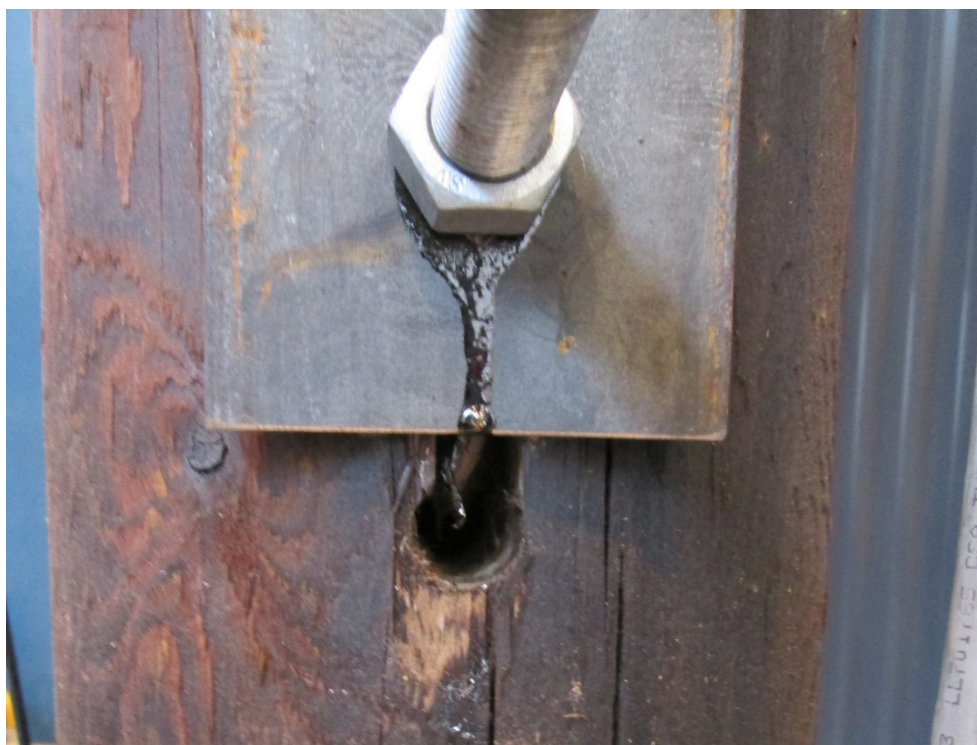
Figur 23: Utfall av provning - pinnbulten skär igenom stolpen.
