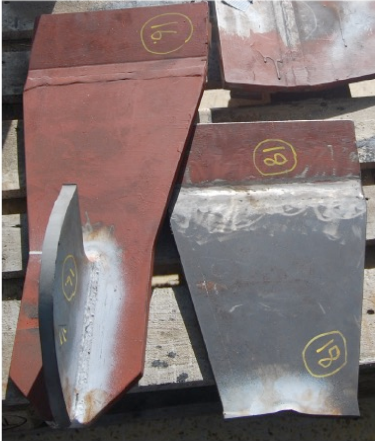
Figur 1: Kopplingselement mellan rotorringen och rotoraxeln som utsatts för utmattningsbrott.
