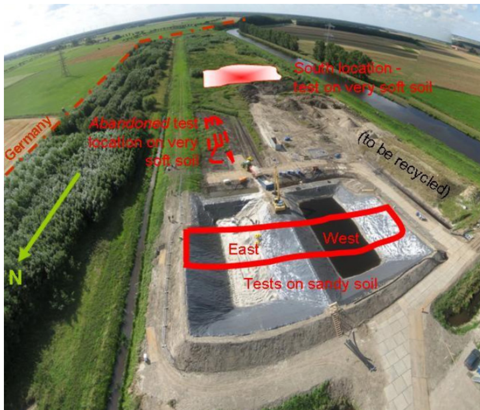
Figur 12 Testplatsen IJkdijk för fullskaleförsök på dammar och invallningar (Koelewijn & Peters 2012).
