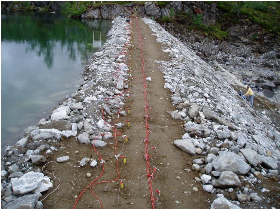
Figur 13 Testdammen i Røssvatn med icke-polariserbara SP-elektroder och resistivitetselektroder längs krönet samt temperaturmätning med sensorer längs nedströms tå.
