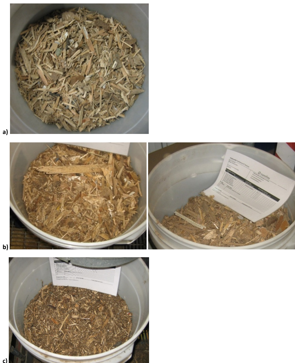
Figur 14. Uttagna bränsleprover; a) Bränsle med bortsållad finfraktion (grovt), b) Referensbränsle, c) Bränsle med tillsatt finfraktion (fint).
