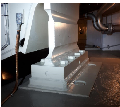
Figur 17 - Fast men flexibel i radiell led som ger lägre laster på grund av termisk utvidgning.
