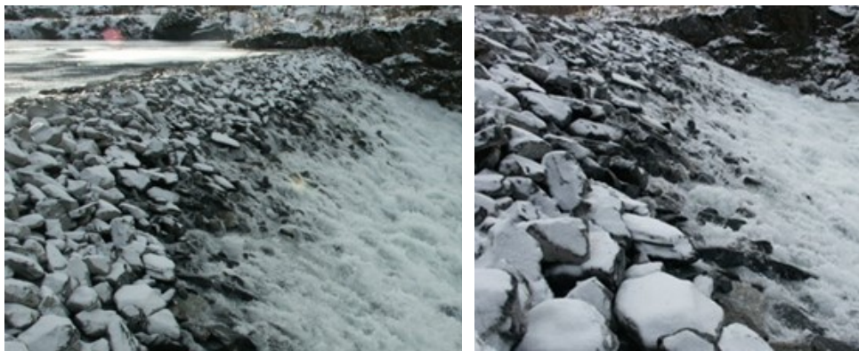
Figur 5 – 2 Ett flertal tester genomfördes med olika styckefall på sprängsten för att få fram förhållandet i EBLs ekvation.
