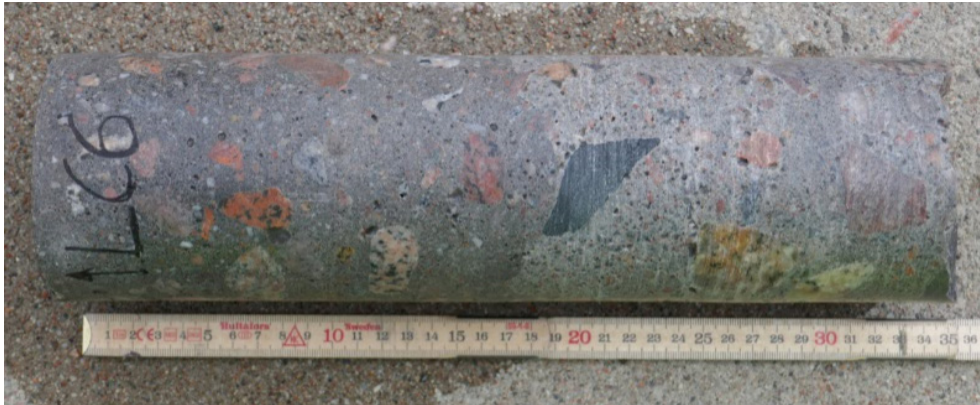
Figur 21. Betongkärna där övergång mellan pågjutning och konstruktionsbetong kan skimras vid 180 mm djup.
