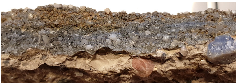
Figur 30. En 20 mm tjock släppa med det gråfärgade Chesterton-bruket överst. Under bruket återfinns ett par millimeter tjockt skikt med svagt gulfärgad betong.
