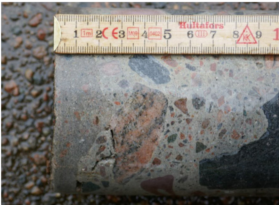
Figur 11. Tjockleken på Densit-lagningen varierade mellan 10 och 15 mm med enstaka djupare partier.
