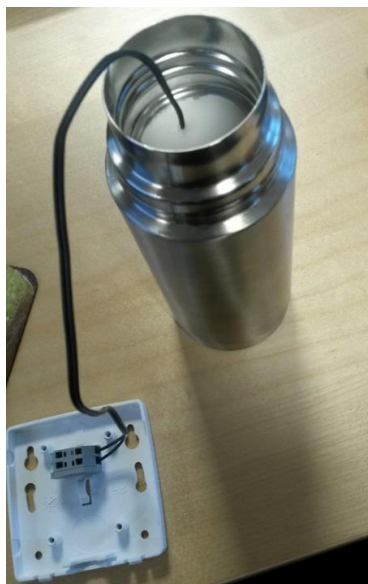
Figur 44. Dämpning genom isolering av utetemperaturgivaren i en termos som ger en fördröjning av temperatursignalen till undercentralen.
