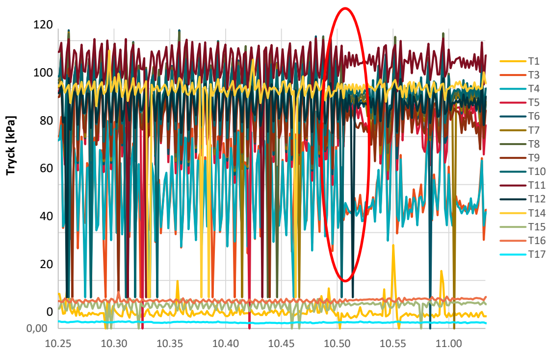
Figur 10. Uppmätta tryck, 0,1 Hz (medel) under provtappningens tidiga del då tappningen ökades från 10 m 3 /s till 12 m 3 /s vilket skedde kl. 10.50. De tidigare högre och starkt periodiska tryckvariationerna minskar och blir mera oregelbundna, vilket kan ses på de flesta givare, exempelvis T3, T4, T11, T15 och T16.
