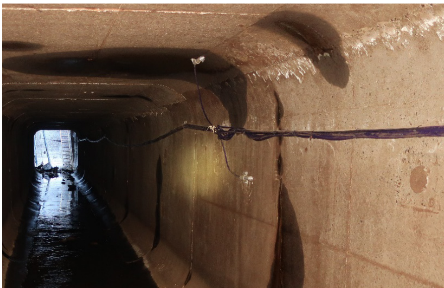
Figur 2. Tryckgivare monterade i tunneln, bilden visar givare T11 och T12.
