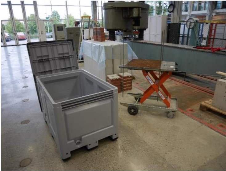
Figur 9. Det plastkar som användes att gjuta betongen i. På saxliftvagnen ligger den tillskurna stålplåten med påsvetsade armeringsjärn vars syfte är att hålla plåten på plats under gjutningen och förhindra att betongen släpper från plåten vid transport av provkroppen.
