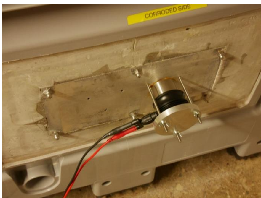
Figur 43. Sändarsensor Panametrics. Grova individuella kablar används för att minska den kapacitiva belastningen på förstärkaren. Den bruna substansen mellan sensorn och aluminiumplattan är konsistensfett. Det används för att få god akustisk koppling.
