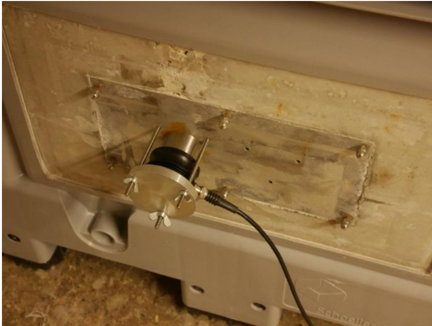
Figur 44. Mottagarsensor Panametrics. Här kan vanlig coax RG 58 användas eftersom det inte rör sig om nämnvärda elektriska strömmar. Mottagna signaler är helt oförstärkta.
