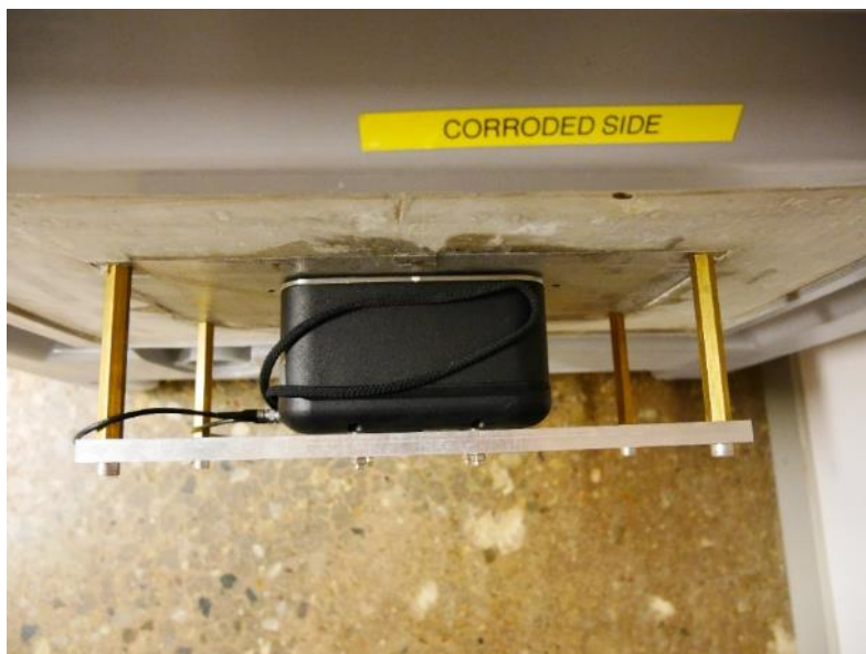
Figur 93. M2502P 100 kHz kompressionsvågtransducer som sändare och mottagare
