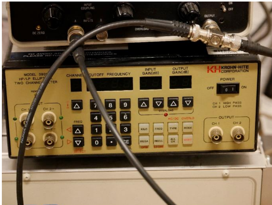
Figur 36. Krohn-Hite variabelt elliptiskt filter med mycket brant selektivitet. Det sker till priset av att utsignalen är fasdistorderad.
