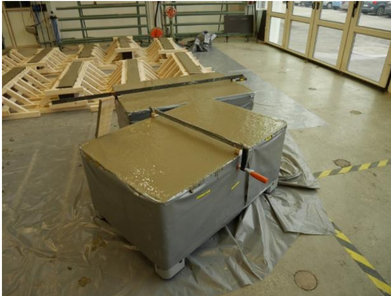
Figur 22. Avslutat gjutningsarbete provkropparna 2-4. Skruvtvingarnas uppgift är att hålla ihop plastkarets sidor tills betongen har härdat.
