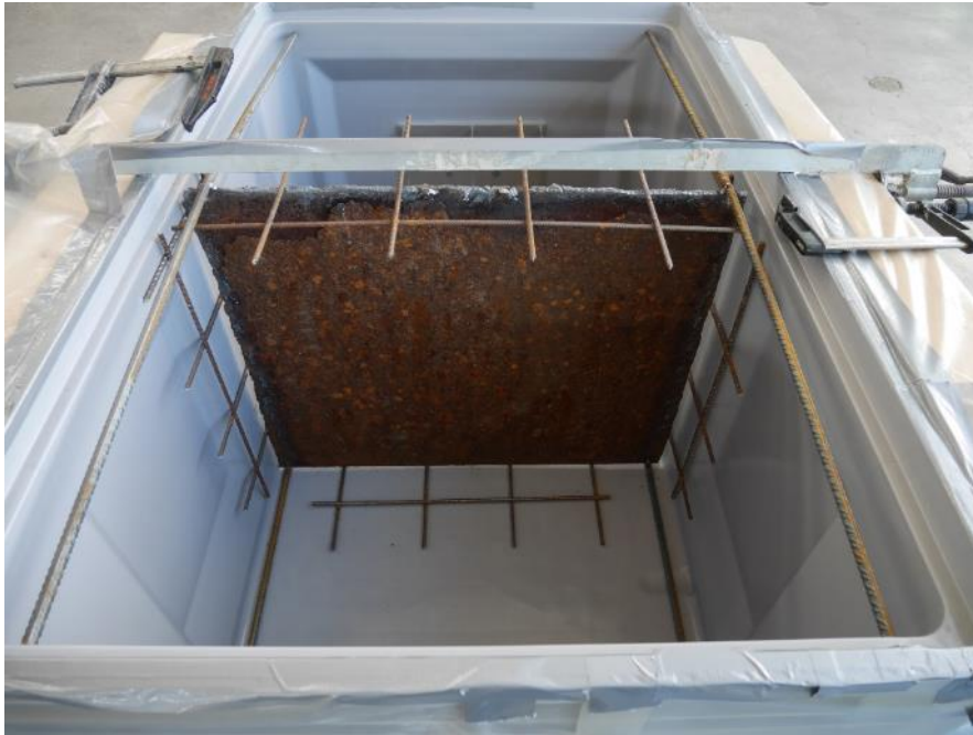
Figur 11. Den korroderade plåten på plats med all armering som kommer att gutas in. Den är avsedd att hålla plåten mitt i provkroppen och vertikalt, samt för att hålla ihop betongen och plåten under transporter. Stålplåten är centrerad.
