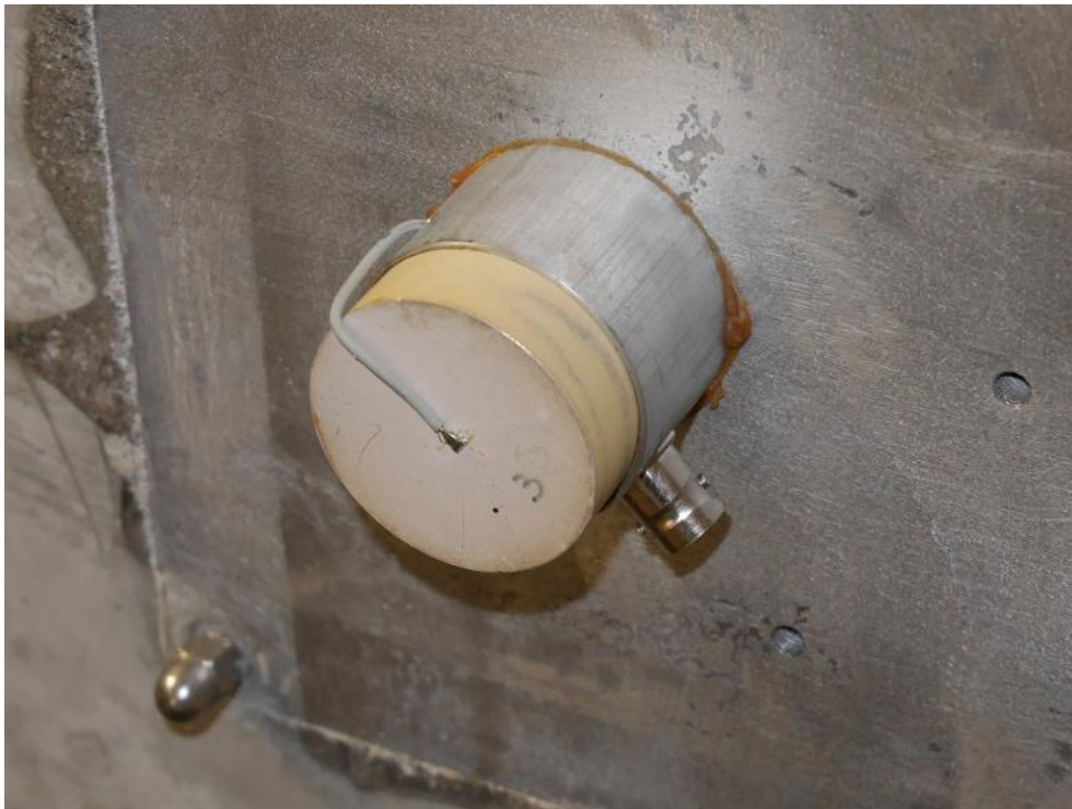
Figur 54. PFTX 3 monterad för mätning tvärs igenom provkroppen. Ett motsvarande montage finns på provkroppens andra sida.
