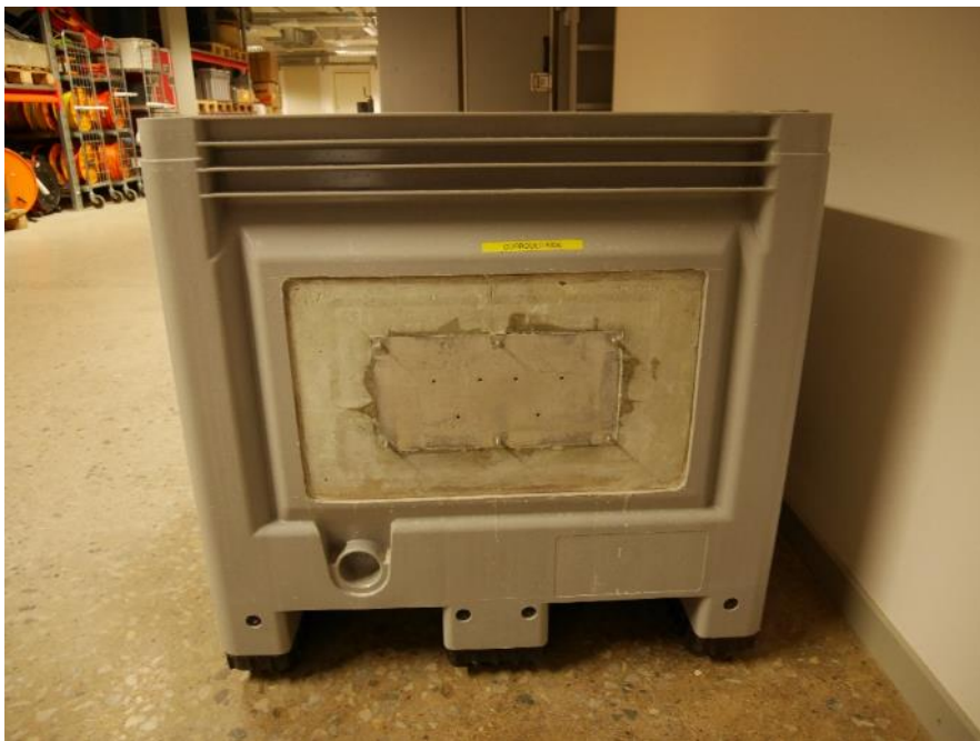
Figur 12. När betongen härdat skars plasten bort på provkroppens kortsidor, varvid de ingjutna aluminiumplattorna blev åtkomliga att fästa sensorer på.
