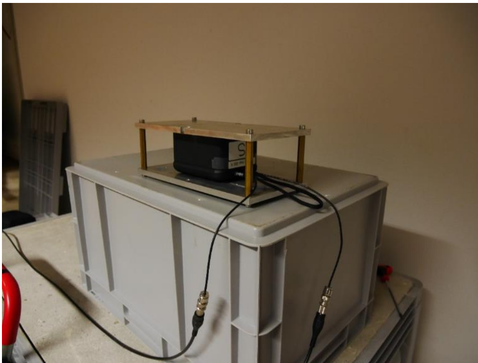
Figur 175. M2502S testas mot en lös aluminiumplatta i syfte att förstå hur plattan påverkar de mottagna signalerna.
