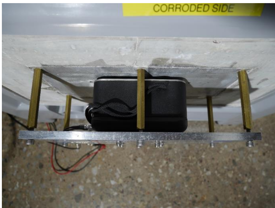
Figur 14. Fastsättning av ACSYS M2502 sensor mot provkropp 2 aluminiumplatta. Denna sensortyp är torrkopplad. 24 avfjädrade stift pressas mot plattan.
