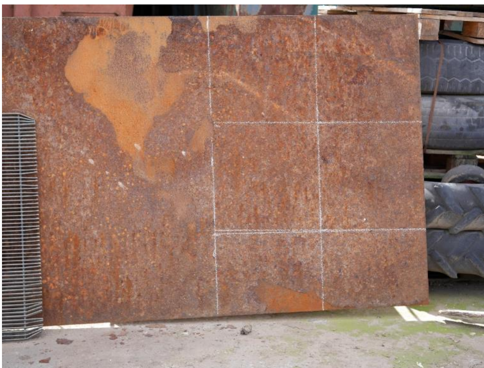
Figur 7. Stålplåt med 8 mm tjocklek och omfattande skalrostangrepp påträffad på företaget Metallteknik utanför Lund. Mindre bitar skars ut med skärbrännare efter de markerade rutorna.
