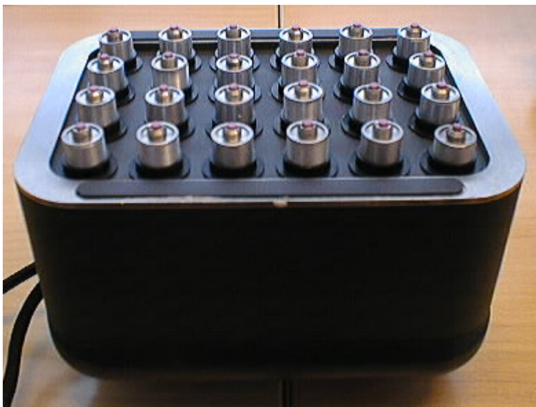
Figur 1. Sökare M2502 från ACSYS för instrumentet A1220 Monolith. 12 element fungerar som sändare och 12 som mottagare. Respektive grupp är parallellkopplad. Det ger riktverkan rakt fram. Alla element är fjädrande, vilket gör att elementen anpassar sig efter ojämnheter i betongen. Sökaren finns dels för 50 kHz skjuvvågor och dels för 100 kHz kompressionsvågor.
