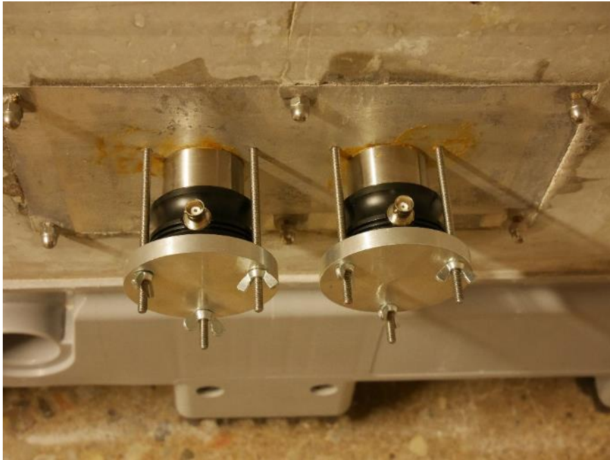
Figur 13. Ett sätt att fästa konventionella ultraljudssensorer på provkropp 1 aluminiumplatta. Den akustiska kontakten mellan sensor och aluminiumplatta underlättas av konsistensfett.
