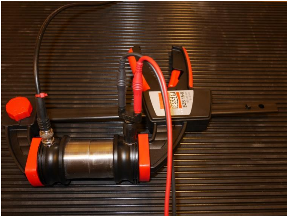
Figur 39. Två Panametrics 50 kHz sensorer hoppressade för mätning av karaktäristik
