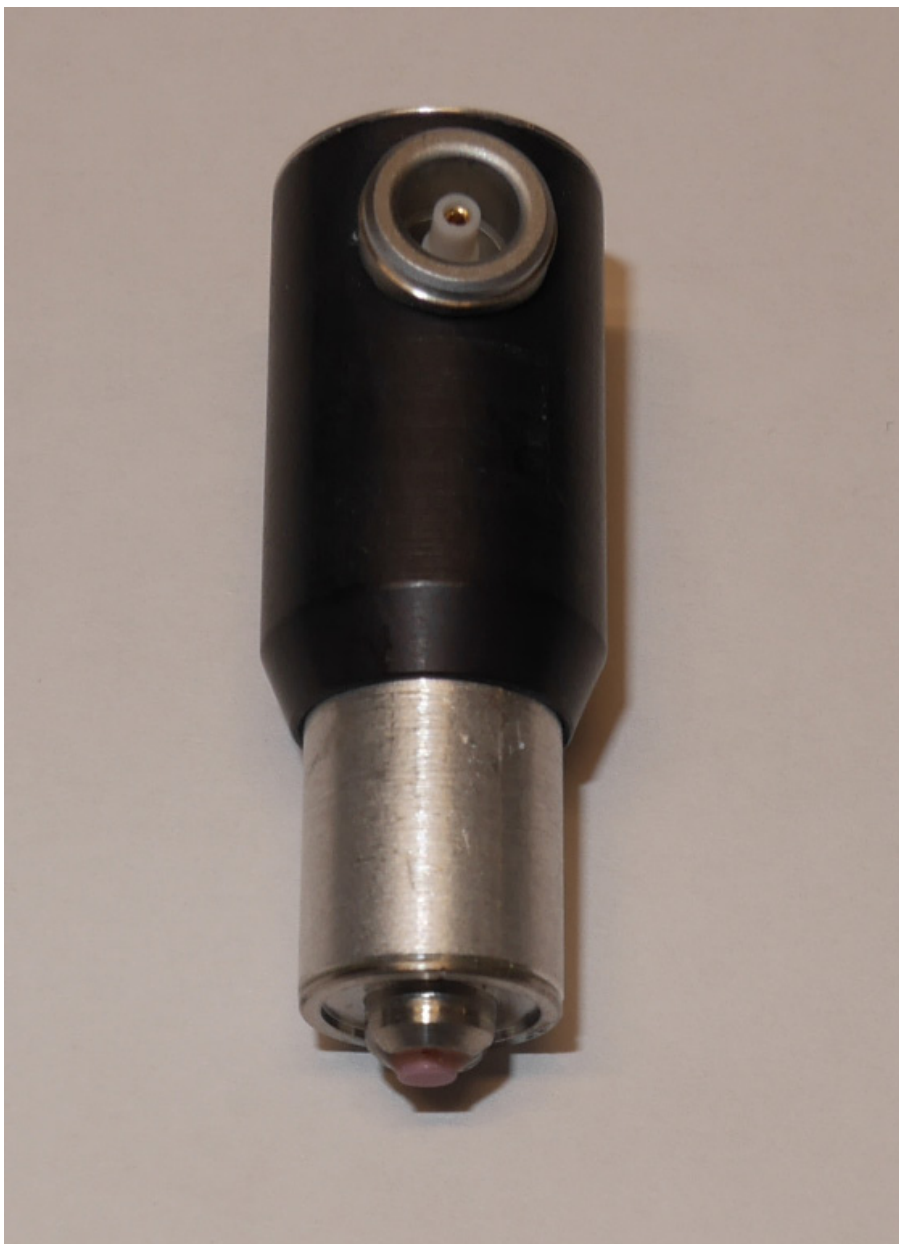
Figur 25. S1802/1803 sensor med ett element av samma typ som i M2502 sensorerna. Dessa sensorer är inte avfjädrade utan man pressar dem mot det objekt som skall undersökas. Den rosa detaljen nedtill är den punkt där vibrationen överförs till provkroppen.
