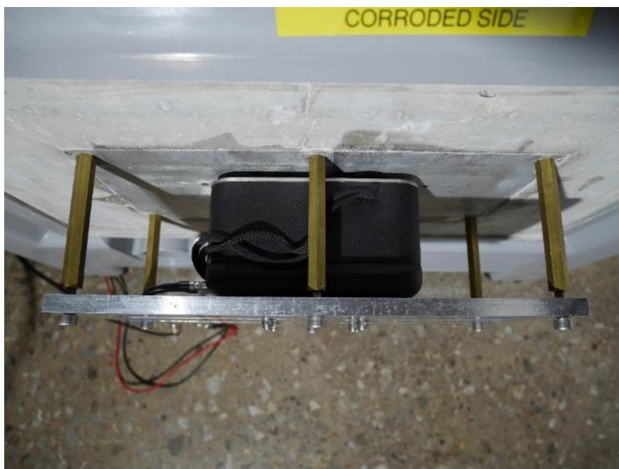
Figur 77. M2502 sensor för kompressionsvågor monterad mot aluminiumplattan på provkroppen. Sensorn är nominellt centrerad kring 100 kHz men den har i verkligheten en resonanstopp vid 127 kHz.
