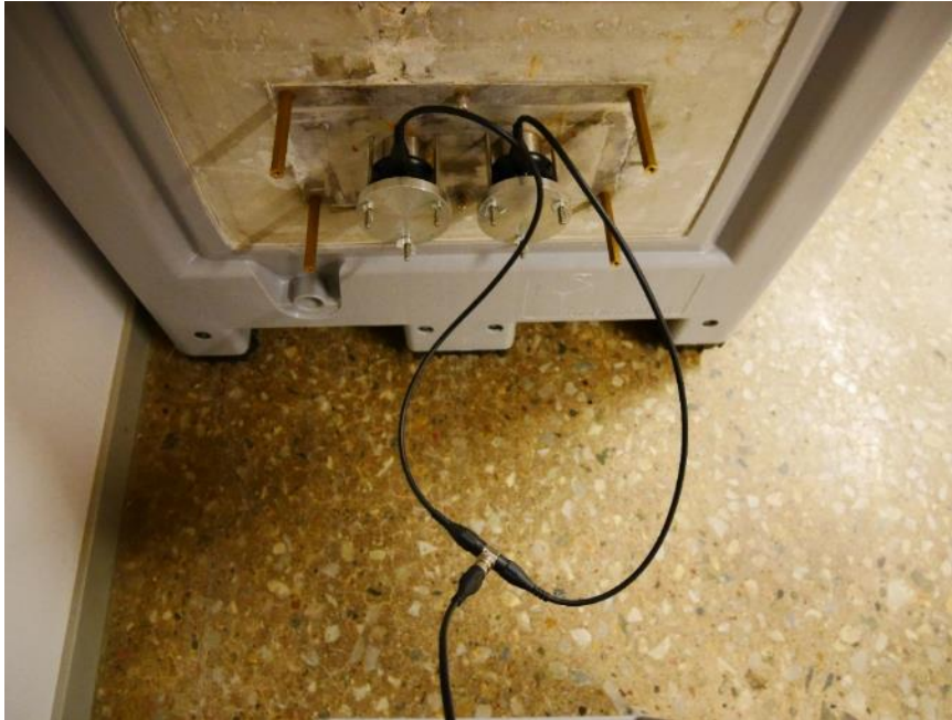
Figur 73. Parallellkopplade Panametrics 50 och 100 kHz sensorer som mottagare i syfte att få bredare frekvensrespons i mottagarledet.
