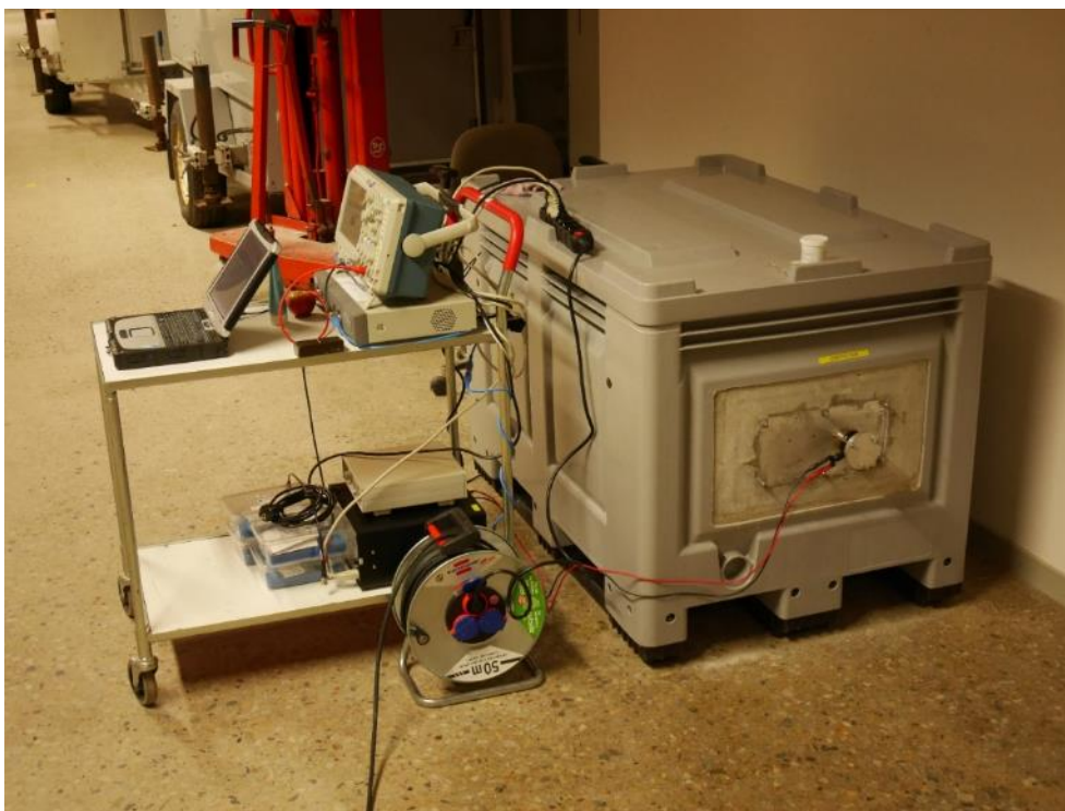
Figur 42. Uppställning för att bestämma frekvenskaraktäristik för sensorer och provkropp.
