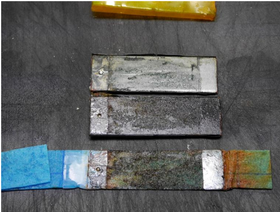
Figur 6. Korrosionsresultat, det uppkom ingen skalrost, inget egentligt rostlager. Däremot små rostgropar, men det fanns ingen rost kvar på plåtarna och alltså ingen grund för olinjärt beteende.
