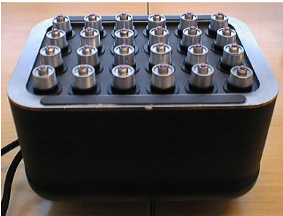
Figur 29. M2502 P och M2502 S ser likadana ut. De består av 24 individuellt fjädrande sensorelement varav hälften är sändare och hälften mottagare. Elementen är kopplade parallellt och det finns en kontakt för sändargruppen och en kontakt för mottargruppen. De tolv elementen på bildens vänstra sida utgör en grupp och de tolv på den högra sidan utgör den andra gruppen.
