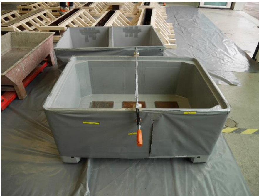
Figur 15. Plastkar med plåtbitar med olika korrosionsnivå i botten. Plåtarna är fastlimmade mot plasten med en omgivande sträng silikon dels för att hålla dem på plats, dels för att hindra att betongen flyter in under dem.
