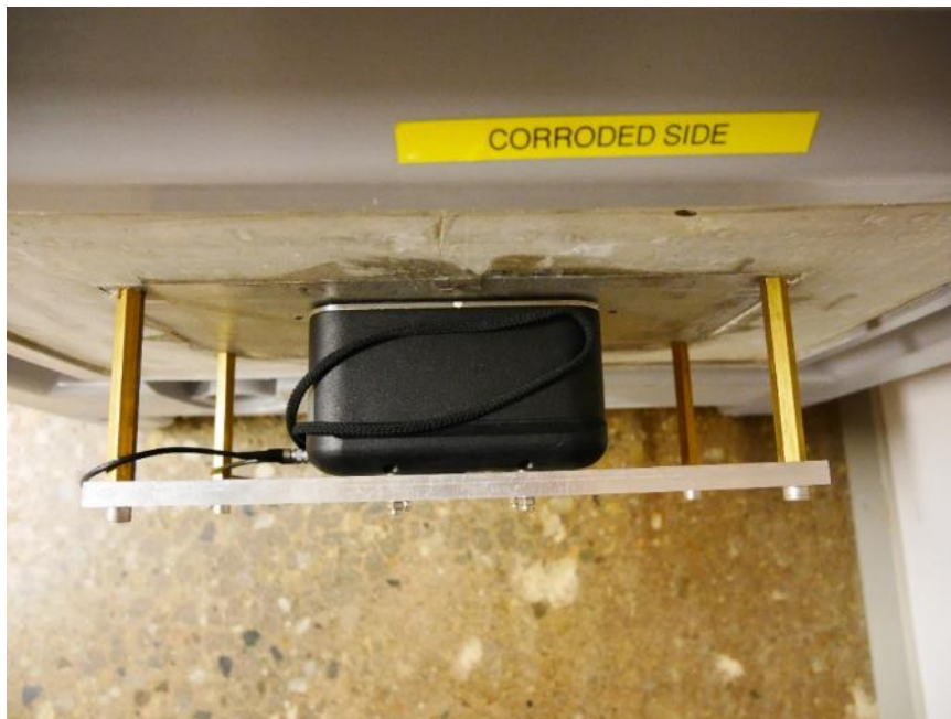
Figur 70. M2502 kompressionsvågsensor. Här endast använd som sändare på sidan med skalrost.
