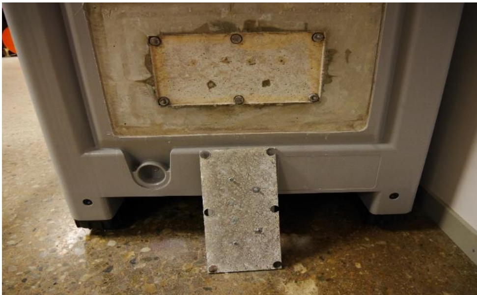
Figur 183. Aluminiumplattan togs bort, då det misstänktes att det uppstod reflektioner inuti den som kunde störa mätresultatet. Vidhäftningen kunde också ifrågasättas då det uppstått en kemisk reaktion mellan aluminium och cement. Detta hade troligen inte inträffat om plattan varit av rostfritt stål.
