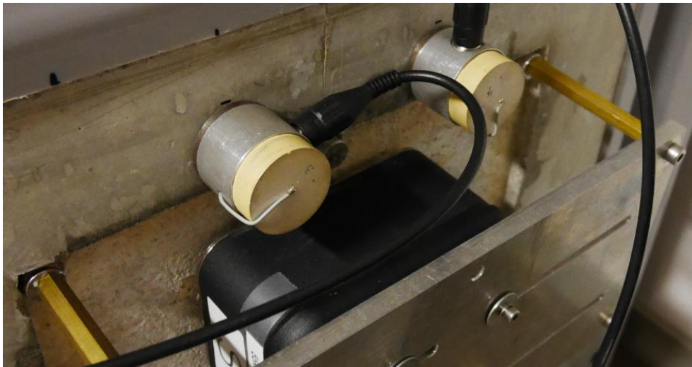
Figur 210 Exempel på montering av de vid LTH tillverkade sensorerna när aluminiumplattan avlägsnats. Sensorerna skruvas fast med hjälp av en M5 stoppskruv i ett gängat hål i de på betongen fastklistrade stålplattorna. Avståndet mellan sensorerna är 120 mm. Som mottagare på andra sidan används 50+100 kHz Panametrics sensorer
