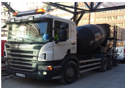
Figur 2 3-axlad roterbil vid den aktuella arbetsplatsen vid Regeringsgatan i Stockholm (TFK)
