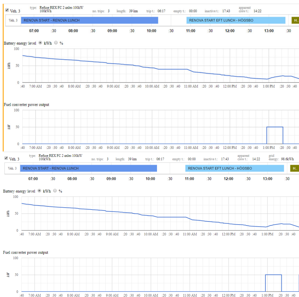
Figur 11: Körbeskrivning, laddstatus och drift av bränslecellssystem för range extender sopbil (100 kW)
