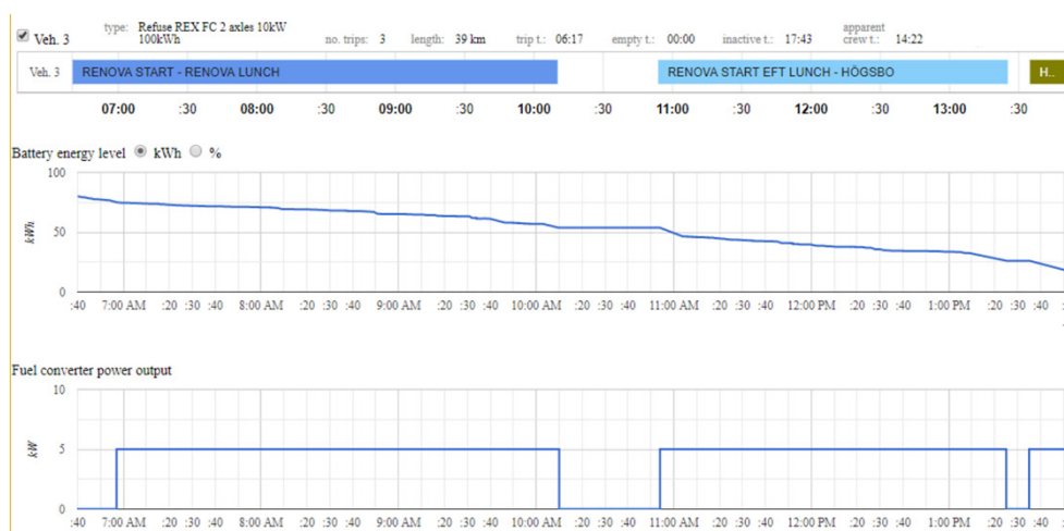
Figur 10: Körbeskrivning, laddstatus och drift av bränslecellssystem för range extender sopbil (10 kW)
