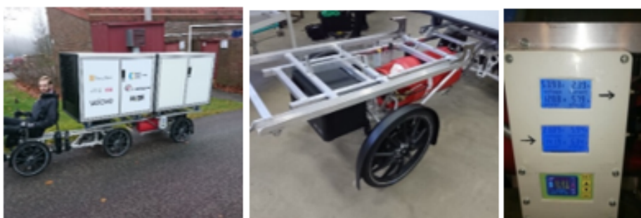
Placering av bränslecellssystemets komponenter. a) vänster: Färdig cykel med kylcontainer och extracontainer, (stående originalbatterier syns bakom föraren), b) mitten: bränslecell (svart) och vätgascylinder (röd), placerad mellan hjulen i underredet, c) höger: dosa för kraftelektronik (som sitter på sidan) med displayer för att visa/mäta spänning, ladd-effekt och verkningsgrad.
