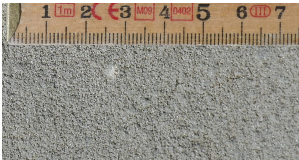
Figur 2. Närbild på lagningsbruk av typ Chesterton ARC 790 V. Notera de förhållandevis fina partiklarna i ytan. Lagningsbruket applicerades i mitten av 1990-talet på sidorna av två utskovspelare. Måttstock som referens.
