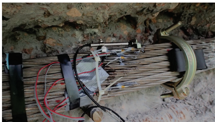
Figur 19 Montering av trådtöjningsgivare och LVDT (lagesgivare) på linor i provningsställe III.
