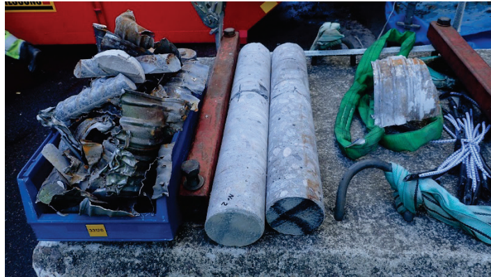
Figur 7 Borrkärnor från djupa borrhinar.
