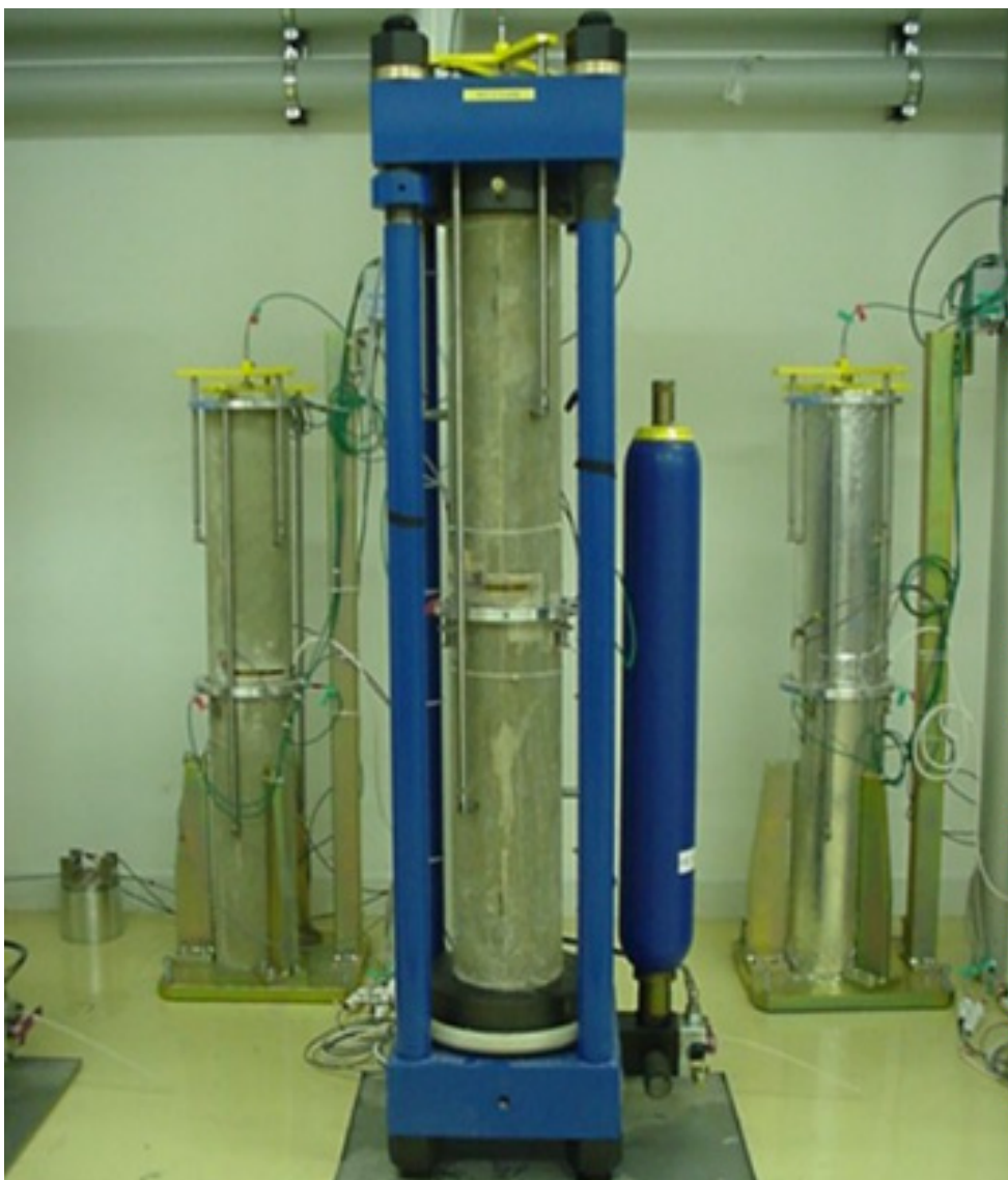
Figur 2-1 Försöksuppställning för bestämning av axiella deformationer på betongcylinder.
