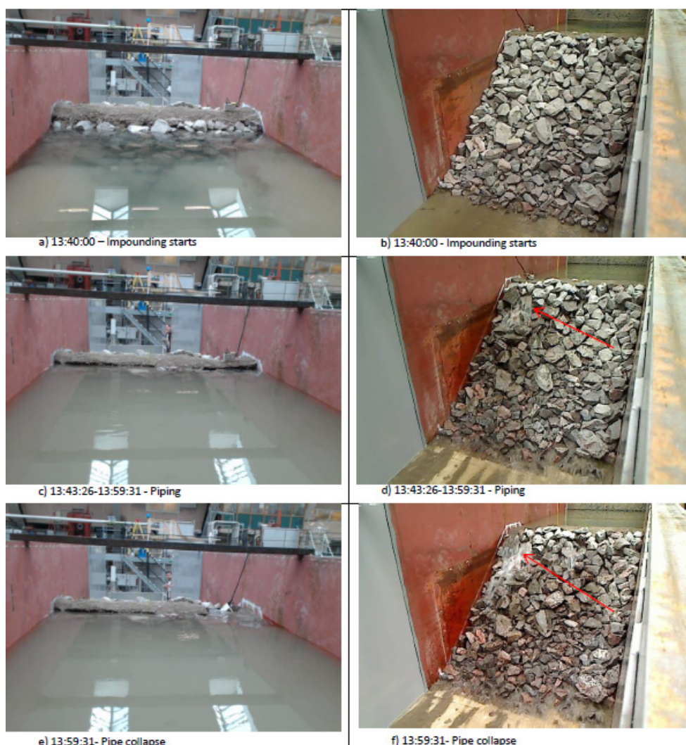
Figur 26. Haveri av reparerat dammkrön vid höga flöden (Vazques 2014). På vänster sida av bilden syns dammens krön från uppströms sida. På den högra sidan syns dammen nedströms. Haveriet skedde högt upp vid dammens högra anslutning. Pilen visar var källsprånget nedströms haveriet inträffade.
