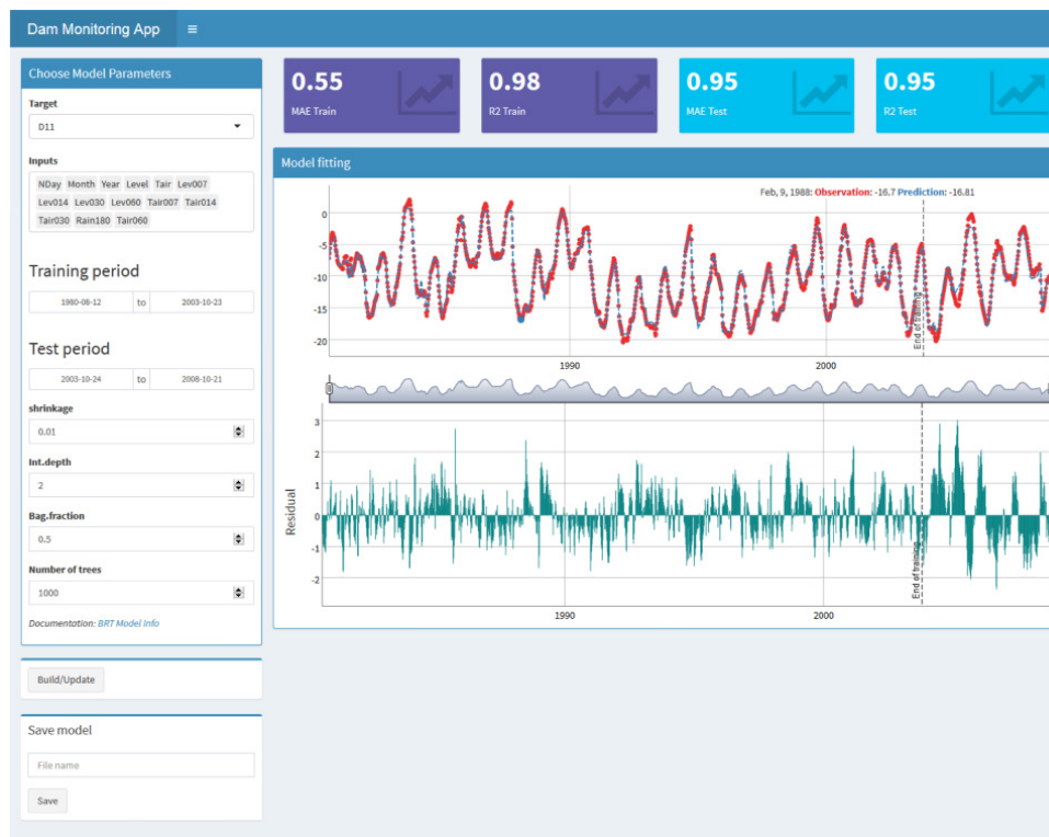
Figur 9. Träning av maskininlärningsmetod (boosted regression trees) på dammsensordata. Från F. Salazar, (2016).
