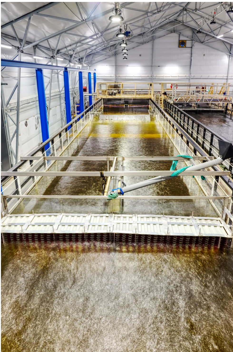
Figur 1. Försökupställning för test av passage av laxsmolt av ett låglutande galler med 15 mm spaltvidd. Vattenfalls laboratorium i Älvkarleby 2018.
