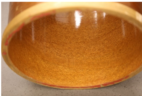
Bild 48a. Förändringar i utseende av pipa H1b efter vattenexponering i 95 °C i två månader.
