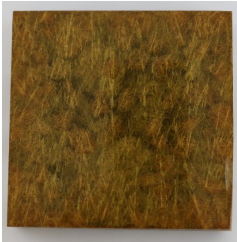
Bild 36a. En kraftig delaminering syns i spärrskiktet på den vattenexponerade provkuponen efter en timmes exponering 200 °C.
