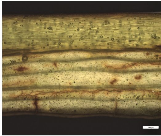
Bild 42a. Tvärsnittet av 95-1 observerat i ljusoptiskt mikroskop med belysning underifrån. Det vita skalstrecket är 2 mm.
