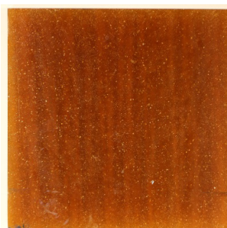
Bild 32a. Spärrskiktet på provkupong innan exponering i vatten.
