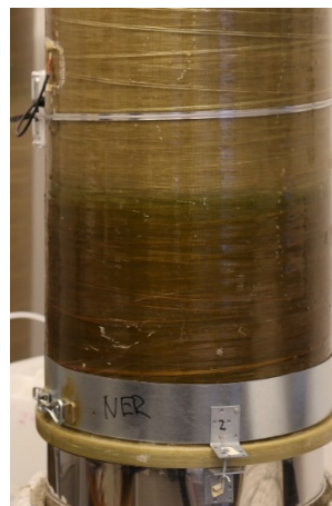
Bild 46b. Brun och grön missfärgning på isolerad del av pipan efter 167 cykler vid 185 °C.
