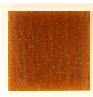
Bild 26a. Insidan (spärrskiktet) av provbiten innan exponering.
