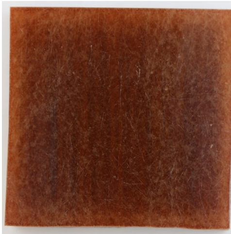
Bild 33a: Spärrskiktet på provkupon efter exponering i 70 °C destillerat vatten i 57 dygn.
