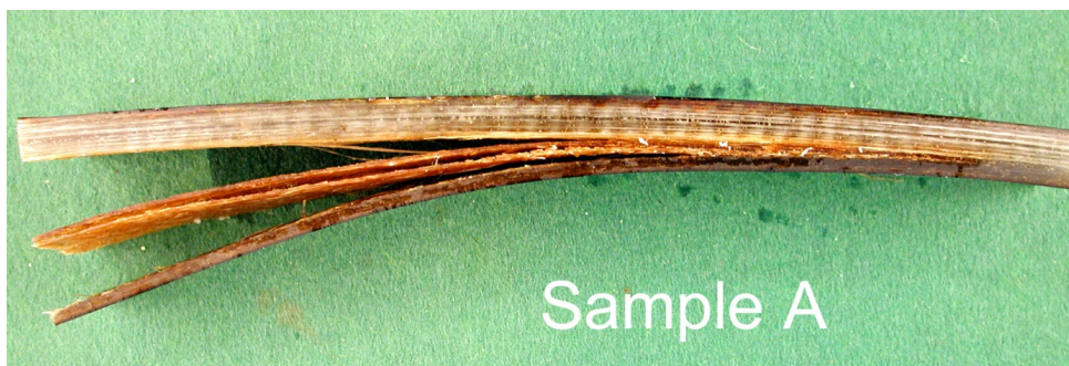
Bild 10c: Delaminering i flera skikt av laminatet.
