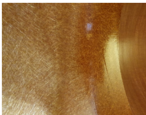
Bild 49b. Kanten mellan H1b (vänster) och H1a (höger) efter 5 cykler vid 200 °C, skillnaden i ytstruktur mellan bitarna är en effekt från vattenexponeringen av H1b.
