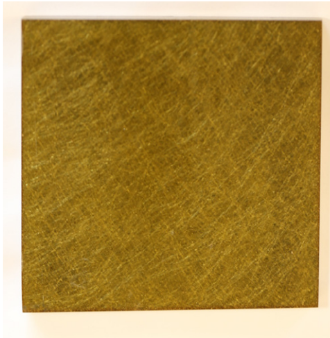
Bild 27a. Efter exponering vid 190 °C i 3 h innan provet svalnat.
