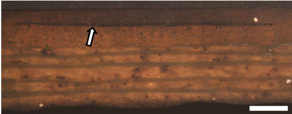
Bild 29a: Mikroskopibild längs tvärsnittet av den streckade linjen i bild 28b efter 96 h vid 200 °C. Den bruna sprickan sammanfaller precis med gränserna på den delamineringen som sedd från ovan. Skalstrecket i bilden är 5 mm.
