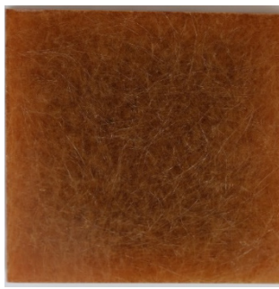
Bild 32b: Spärrskiktet på provkupong efter exponering i 95 °C destillerat vatten i 35 dygn.
