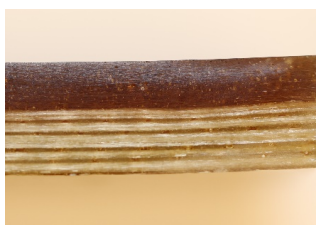
Bild 26b. Tvärsnitt av oexponerad provbit, där det bruna skiktet är spärrskiktet och det ljusa skiktet är styrkelaminatet.
