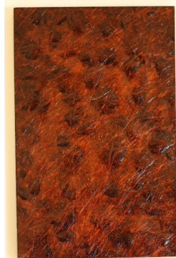
Bild 37b. Vattenmättad provkupon exponerad vid 210 °C i 28 h.
