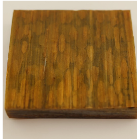
Bild 36a. Baksidan av den vattenexponerade provkuponen uppvisar också en kraftig delaminering efter en timmes exponering vid 200 °C.
