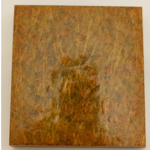
Bild 37a. Vattenmättad provkupon exponerad vid 210 °C i 1 h.
