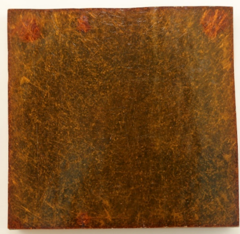
Bild 41b. 95-1 efter 2 antal cykler till 200 °C.
