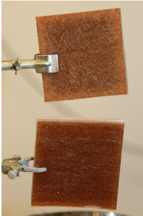
Bild 39a. Provkuponger 95-1 (övre) och 70-1 (nedre) innan första temperaturcykeln.
