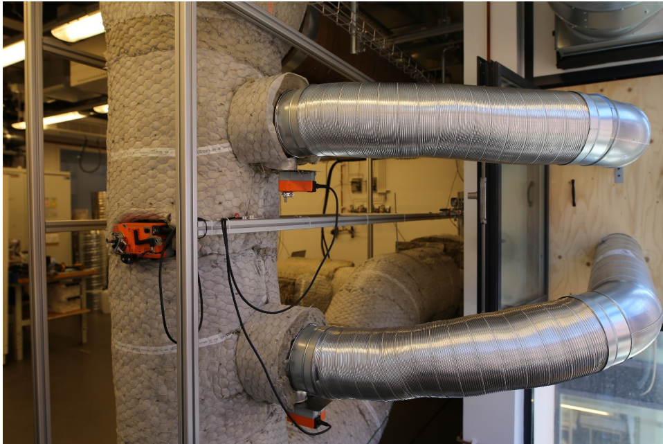
Bild 19. Spjäll för att ge möjlighet till cyklisk temperatur
