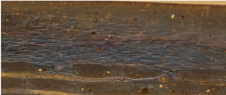
Bild 27c. Kantfoto av spärrskiktet efter exponering vid 190 °C i 3 h. Foto visar den kant som delamineringen propagerat mot.
