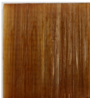
Bild 32c: Baksidan på provkupong efter exponering i 95 °C destillerat vatten 35 i dygn vatten.
