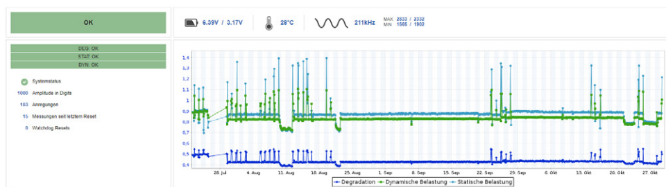
Bild 52. Statussida för sensorn monterad på pipa V1. Den mörkblå linjen visar degradering, den gröna visar dynamisk spänning och den ljusblå statisk spänning för de senaste 100 dagarna.
