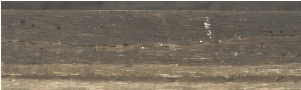
Bild 33c: Mikroskopibild av tvärsnittet av delamineringen som syns i spärrskiktet.
