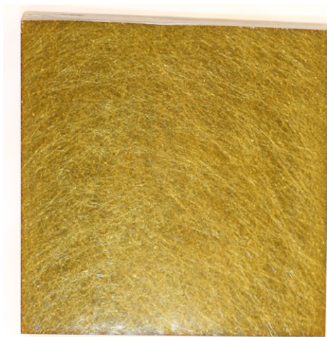
Bild 28a: Spärrskiktet efter exponering i 3 h vid 200 °C direkt efter uttagen ur ugn.
