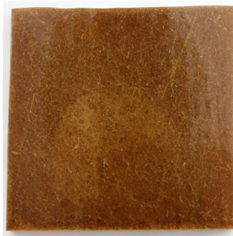
Bild 33b: Spärrskiktet efter 1 timmes exponering vid 170 °C.
