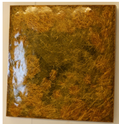
Bild 34b: Inga större skillnader syns efter 4 h, utan tydligast syns en mer generell ökad brunfärgning av provkupongen.
