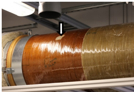
Bild 48b. Färgförändring för oexponerad (till höger) och efter exponering (till vänster) i vatten vid 95 °C i två månader.
