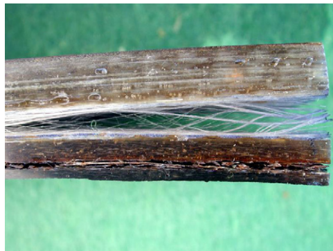
Bild 5b: Tvärsnitt av delaminerat GAP-laminat. Även i spärrskiktet (nedå i bilden) syns en ytlig delaminering.
