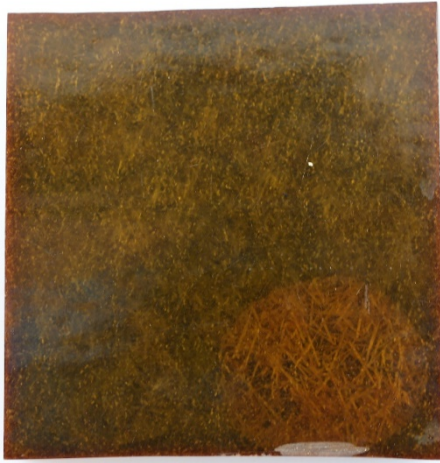
Bild 41a. 70-1 efter 2 antal cykler till 200 °C.
