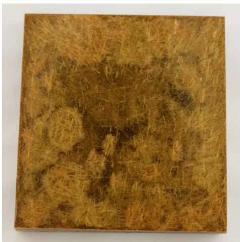
Bild 34a: En kraftig delaminering syns på den vattenexponerade provkupongen efter bara en timmes exponering 190 °C.
