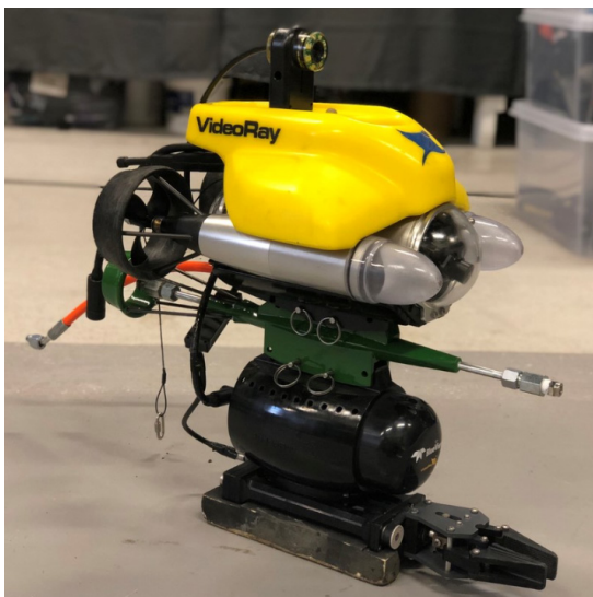
Figur 14: Exempel på en liten ROV för mindre tunnlar eller delar nära t.ex. tunnelmynning.
