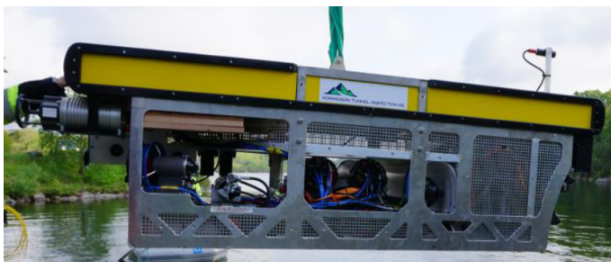
Figur 16: ROV med batteridrift. Ellingsen (2019).
