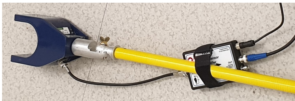
Figur 3-3. Kapacitiv sensor från Techimp monterad på en isolerstång.
