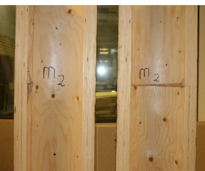
Insidan av övre delen av mittsektionen m2 såg torr och fin ut
