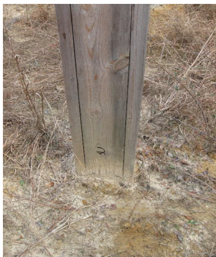
Figur 11. Kontrollstolpe nr 2 utan stål nät efter 10 månaders exponering. Medelfuktkvoten för kontrollstolparna var 19,4 % ca 10 cm ovanför markbandet. Vid och ca 10 cm under markbandet var den 32 %, indikerande höga fuktkvoter även i de stål nät försedda stolparna.
