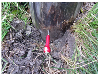
Stolpe nr 7. Syl trängde in 14-16 mm strax under markbandet
