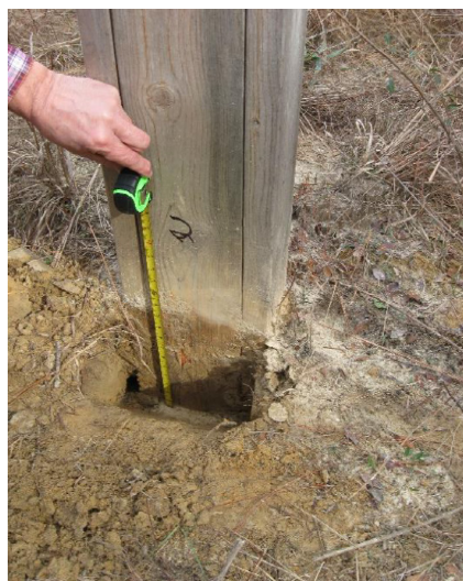
Figur 11. Kontrollstolpe nr 2 utan stål nät efter 10 månaders exponering. Medelfuktkvoten för kontrollstolparna var 19,4 % ca 10 cm ovanför markbandet. Vid och ca 10 cm under markbandet var den 32 %, indikerande höga fuktkvoter även i de stål nät försedda stolparna.
