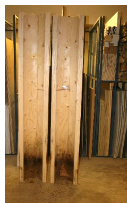
Nedre delen av mittsektionen visar markbandet med tydlig påväxt av missfärgande svamp på insidan och angrepp av röta i de yttre fanéren på utsidan
