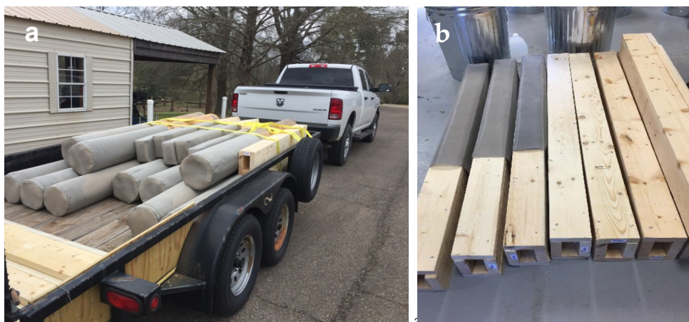
Figur 5. a. Fanerstolpar och andra provstolpar upplastade för transport till försöksfältet i Saucier, Mississippi. Lägga märke till stålnätet runt delen som ska stå i marken. b. Kontrollstolpar av gran med och utan stålnät.
