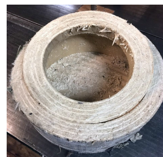
Det inre röret går inte ända ner till bottenplattan
