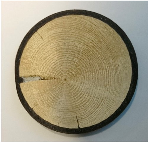
Figur 32. Tvärsnitt av WOPAS plastbelagda ledningsstolpe
