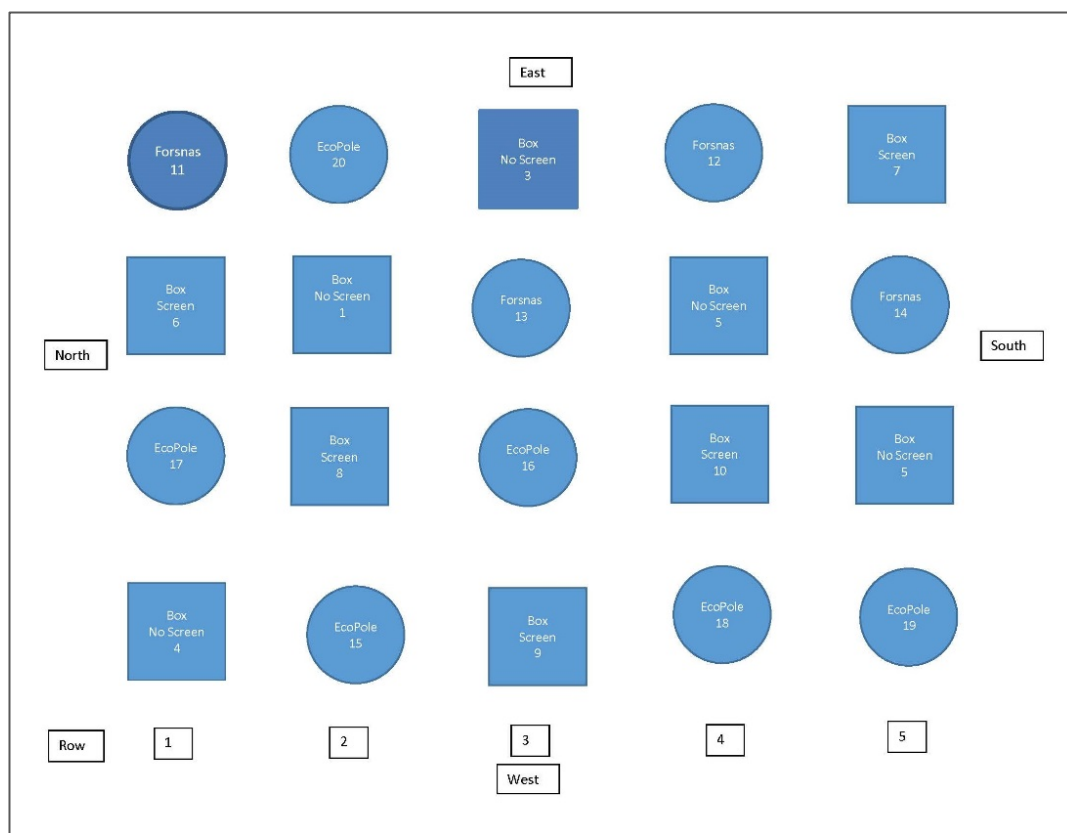
Figur 6. Plan över prov- och kontrollstolpar i fältet i Saucier, Mississippi.
