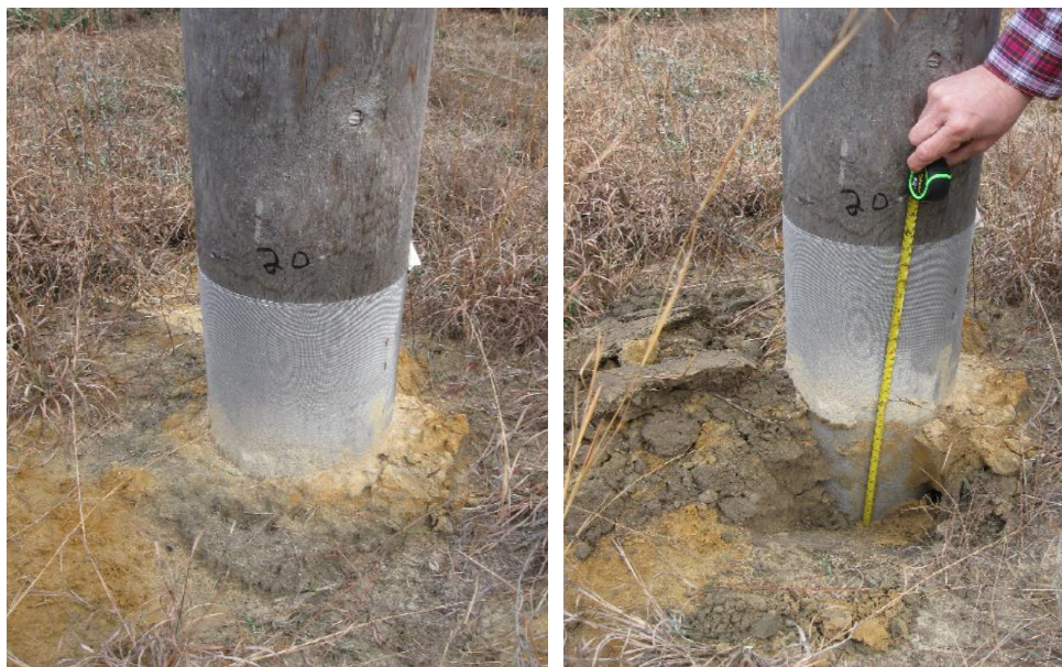
Figur 12. Ecopole nr 20 efter 10 månaders exponering. Medelfuktkvoten för Ecopole provstolpar var 16,5 % ca 45 cm ovan markbandet. Observera att marken vid och under markbandet i bilden t h är fuktig, vilket indikerar en fuktkvot i stolpen på över 30 %.
