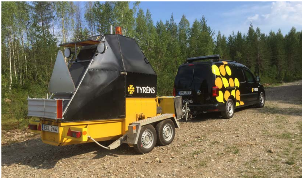
Figur 6. Vagn för mätning med fallvikt (FWD).
