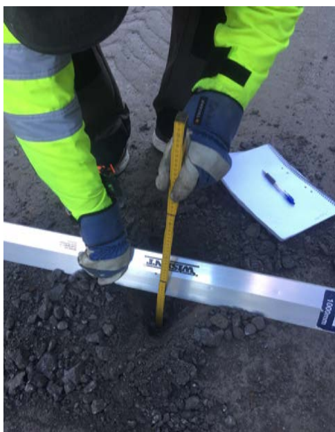
Figur 7. Mätning av lagertjocklek efter upptagning av provgrop.
