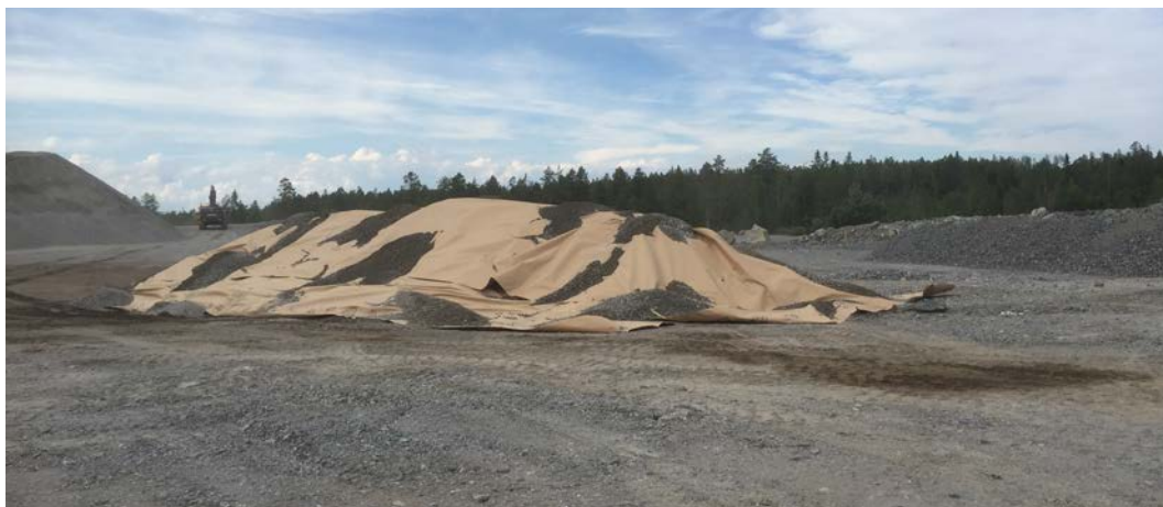
Figur 15. Lagring av aska under täckpapp vid bergtäkten i Fjäl.
