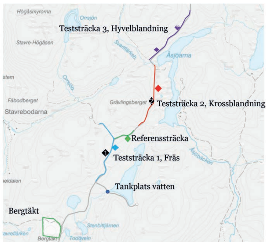
Figur 1. Utsträckning av testväg 1 samt plats för tillredning och upplag. Provpunkterna för vattenproverna är markerade med kvadrater: före upprustningen (svart) och efter upprustningen, teststräcka 1 (blå), referenssträcka (grön), teststräcka 2 (röd) och teststräcka 3 (lila).
