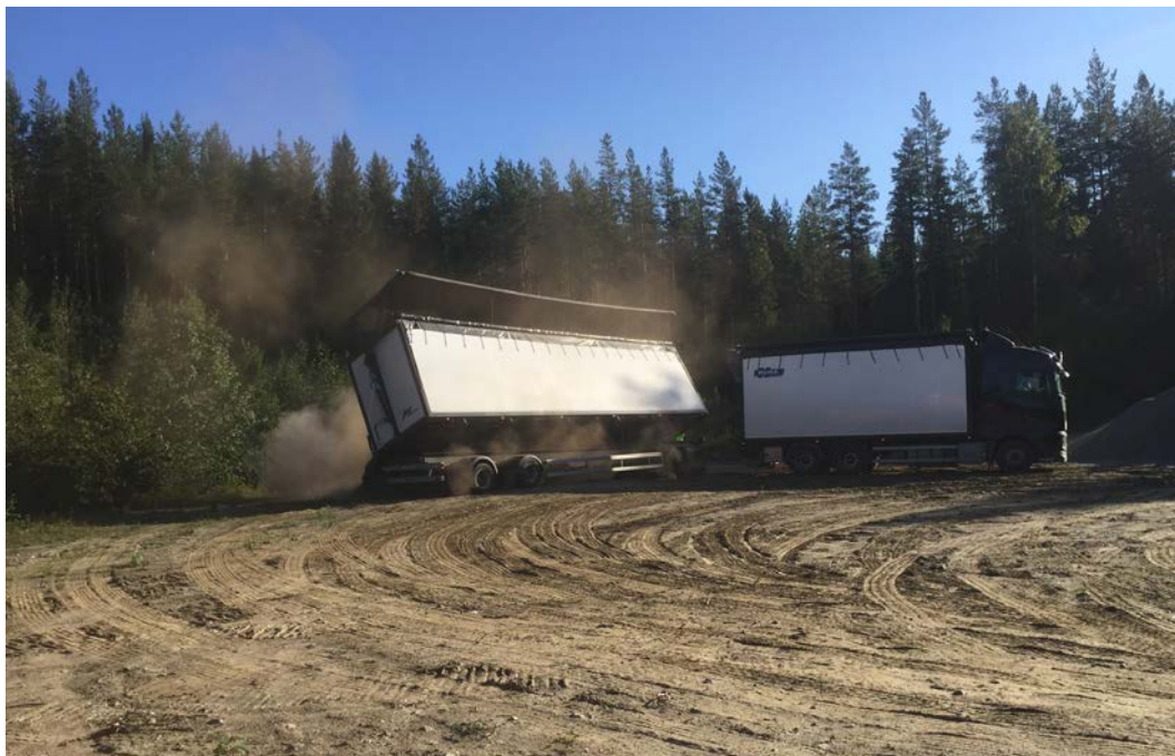
Figur A12. Lossning av aska vid upplag med flisbil.
