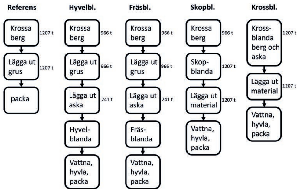
Figur 29. Flödesscheman för de olika metoderna. Vissa av momenten är identiska eller skiljer bara i kvantitet. Processerna avser i samtliga fall utläggning av ett 100 mm tjockt bärlager på den 1050 m långa sträckan.
