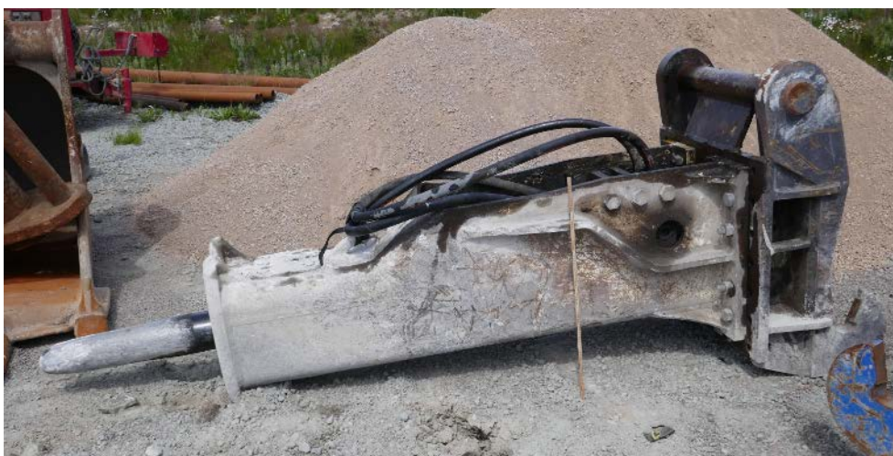
Figur 70. Hydraulhammare. Betongen spräcks genom kraftfulla slag med det utstickande spettet (till vänster).
