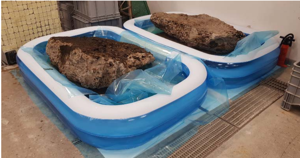
Figur 79. Två betongstycken placerade i vattenfyllda bassänger vid Lunds Tekniska Högskola.
