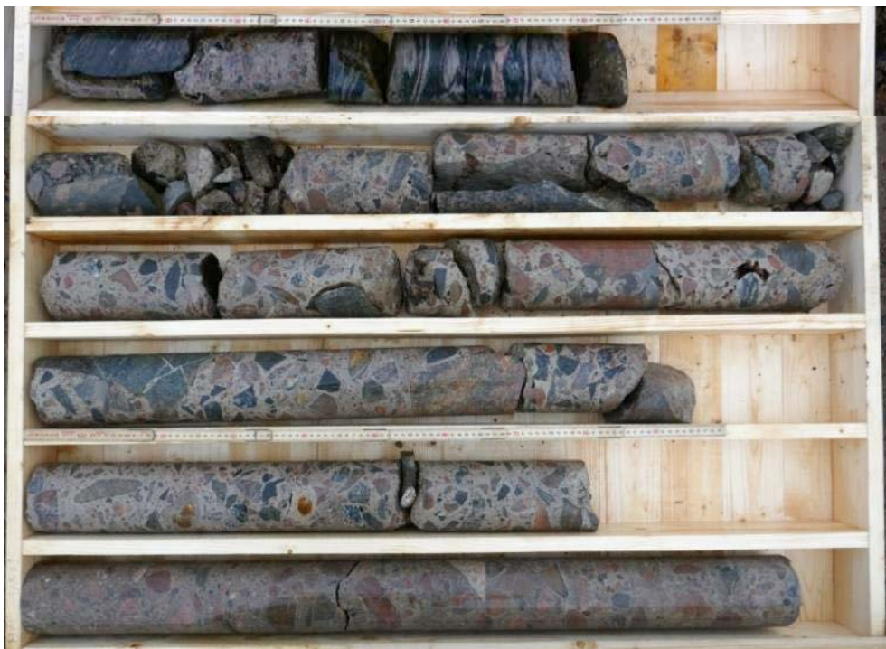
Figur 54. Betongkärna US. Krönets yta ned till vänster. Kärnans totala längd 5,8 m. Meterstock som referens.
