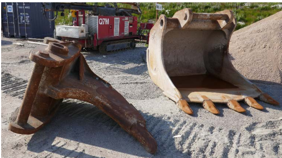
Figur 69. Två redskap som kan monteras på grävmaskinens skaft. Tjälkrok till vänster och skopa till höger.
