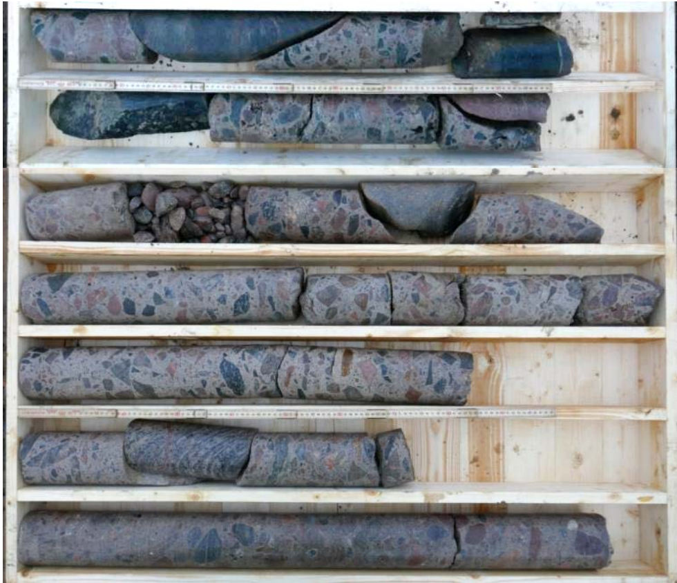
Figur 53. Betongkärna NS. Krönets yta ned till vänster. Kärnans totala längd 6,9 m. Meterstock som referens.
