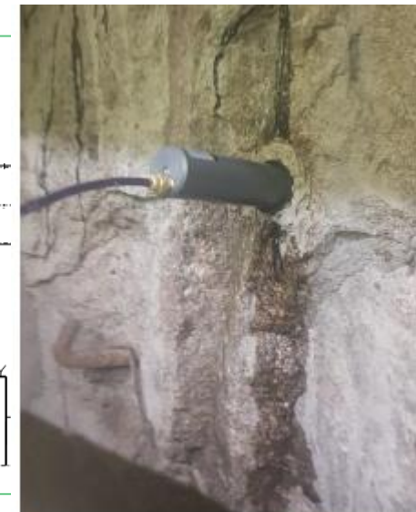
Extensiometer monterad i berget.
