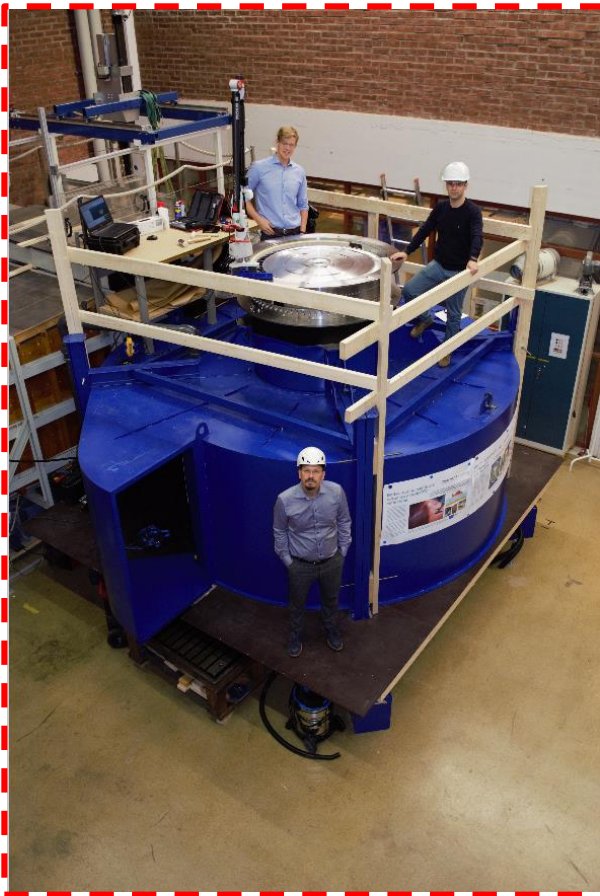
Testrigg kompressor & förvärmare, ©Chalmers
