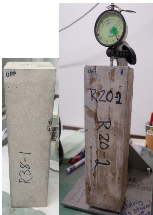
Figur 2-11. Provkropp och uppställning för mätning av längdutveckling till följd av AKR.
