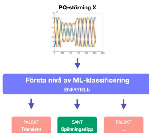
Figur 3: Översikt för klassificering av PQ-störningar
