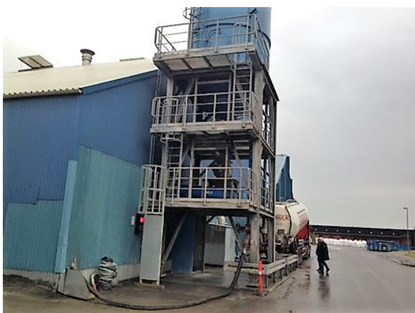
Figur E - 1 Lossning av aska från lastbil. Foto: Kristian Peders
