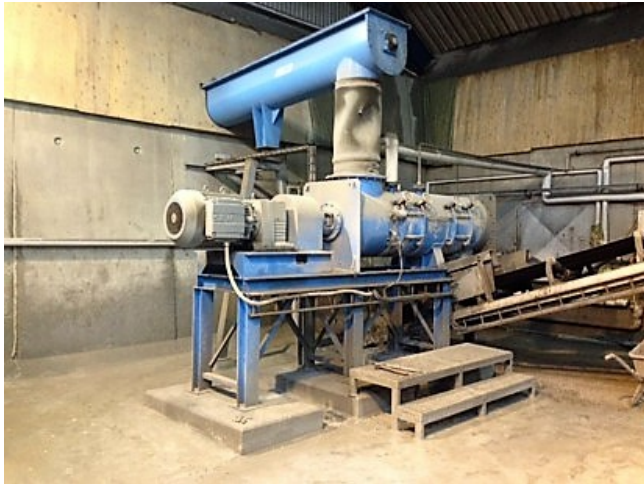
Figur E - 2 Mixer för att blanda aska och vatten. Foto: Kristian Peders
